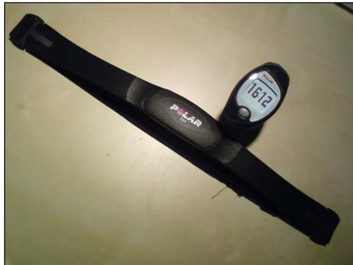
Abbildung 5: Pulsmessgerät mit Transmitter-Brustgurt
