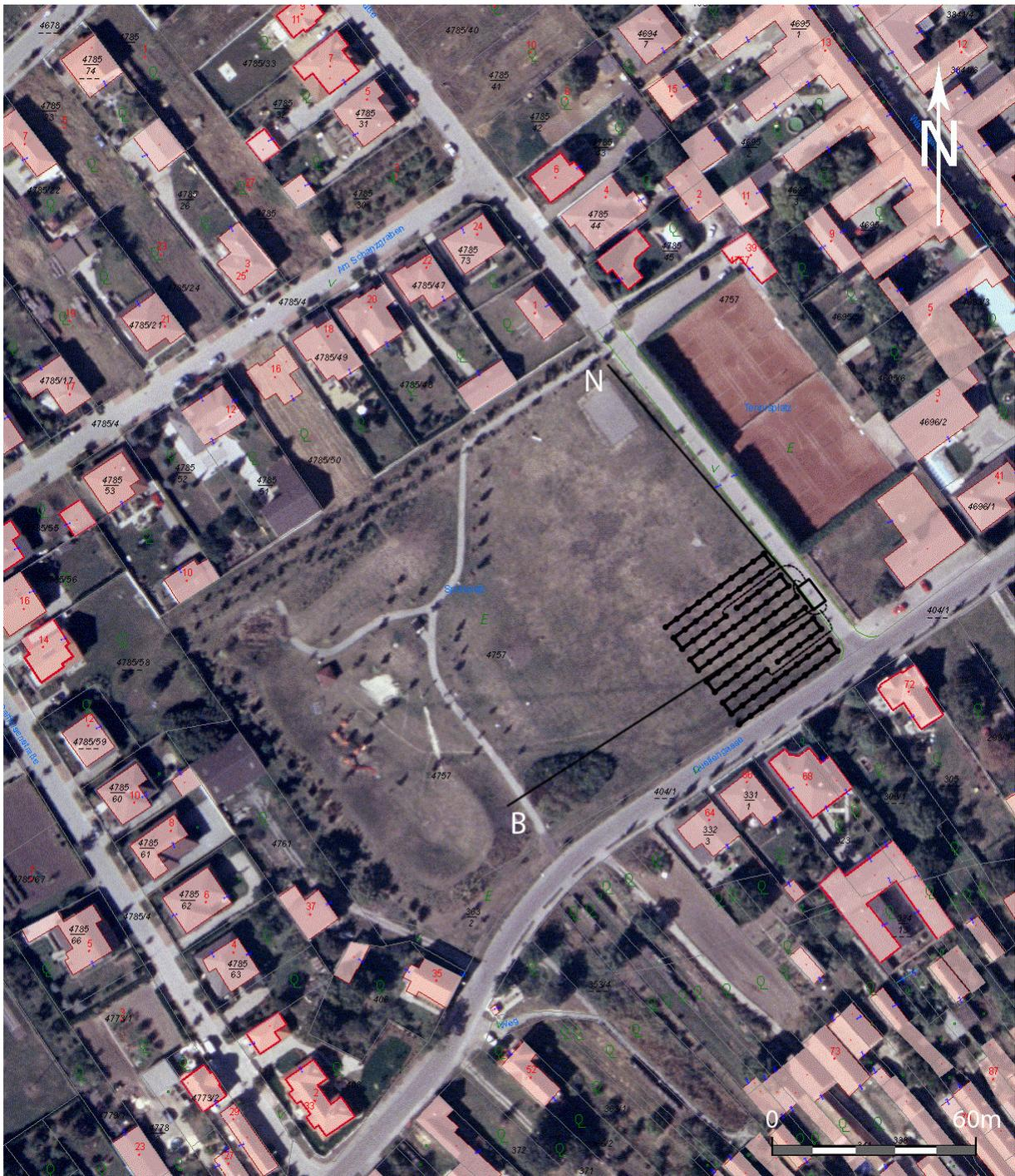
Abbildung 7.4.7: Orthofoto mit Auslage einer Pol-Pol (2D)-Anordnung mit den in einiger Entfernung gesetzten "Außenelektroden" B und N.
