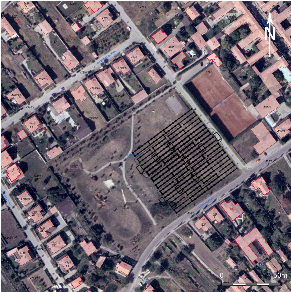
Abbildung 7.4.8: Orthofoto mit neun Pol-Pol (2D) Auslagen mit einer 50 prozentigen Überlappung, welche ein Areal von 76x76 Metern abdeckt.
