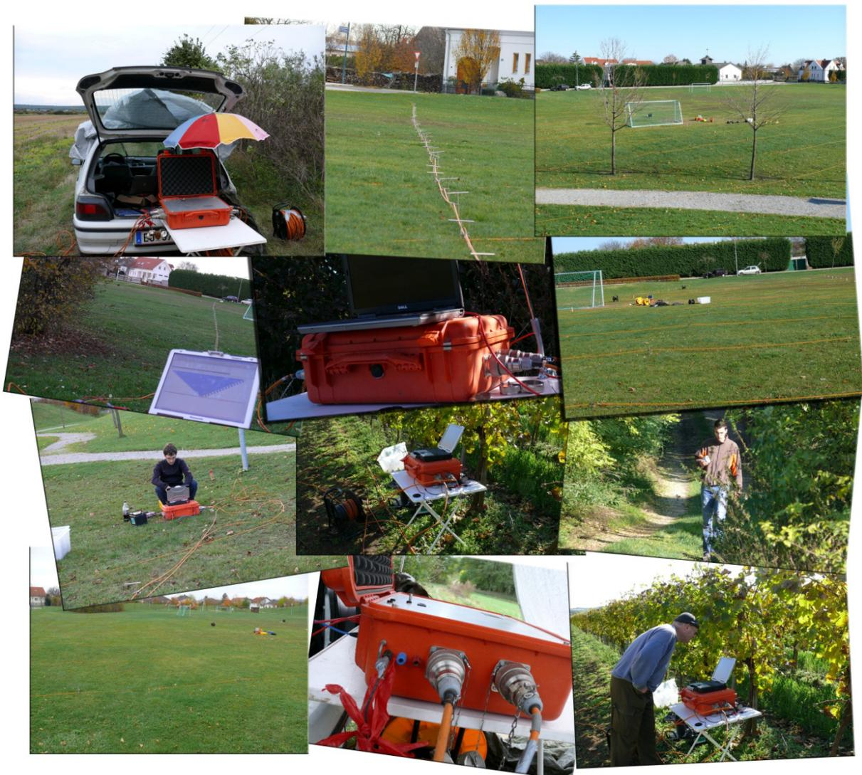
Die geoelektrischen Messungen wurden in mehreren Kampagnen im Jahr 2008 an vier verschiedenen Orten durchgeführt. Für die Messungen wurde das Gerät GeoTom MK4E100-RES/IP (Firma Geolog2000: [www.geolog2000.de](http://www.geolog2000.de)) verwendet.
