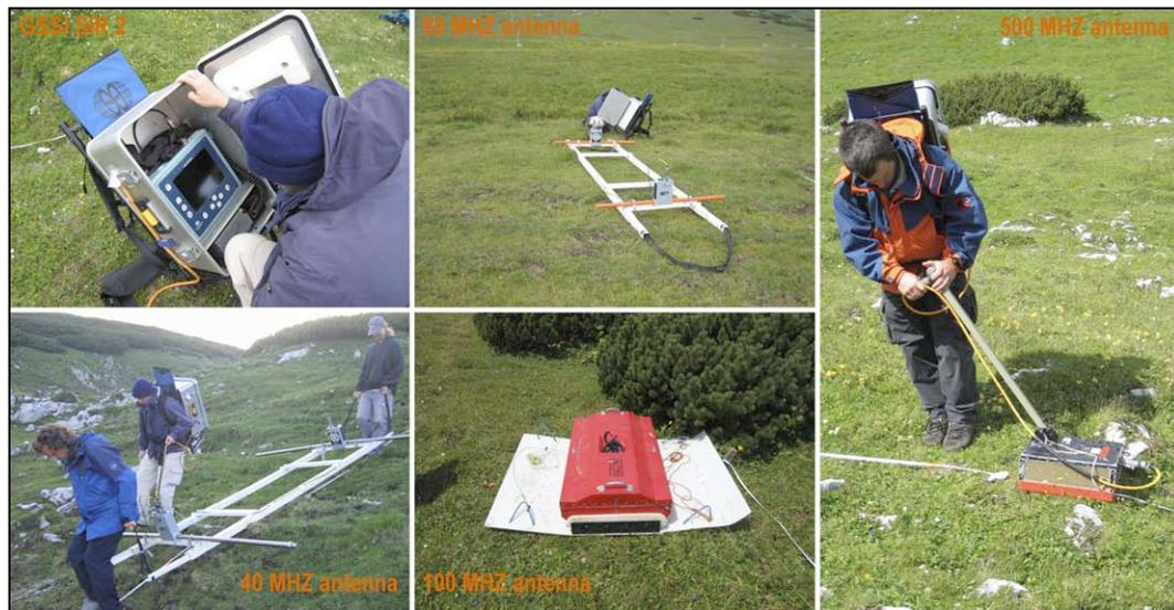
Abbildung 9: Georadar mit Antennen.
