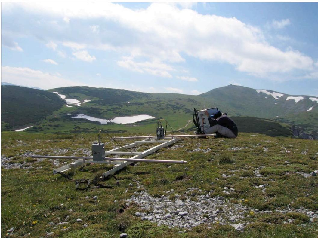
Abbildung 27: 40 MHz Antenne bei Profil 1.
