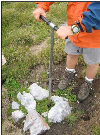
Abbildung 11: Entnahme einer Bodenprobe
