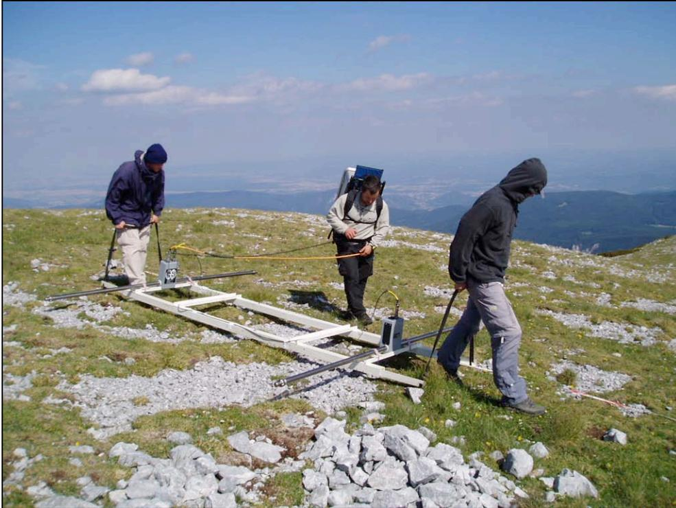
Abbildung 17: Messung mit der 40 MHz Antenne, Profil 1 (Blickrichtung Ost).
