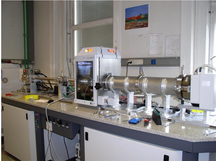
Abbildung 3.4.: Die Röntgenkleinwinkelstreuanlage NANOSTAR. Links im Bild befindet sich die Kupfer-Drehanode, dahinter der Hochspannungsgenerator. Der Strahl läuft durch ein dreifaches Blendsystem, wird an der Probe in der Probenkammer gestreut und in einstellbarer Entfernung mit einem 2D-Detektor registriert (rechts im Bild).
