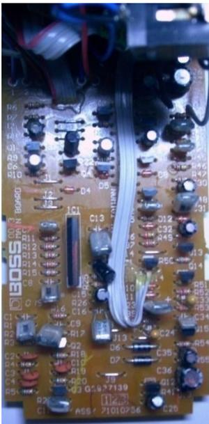
Abbildung 29: Innenleben des OD-3 mit dem IC auf der Platine (IC1)
