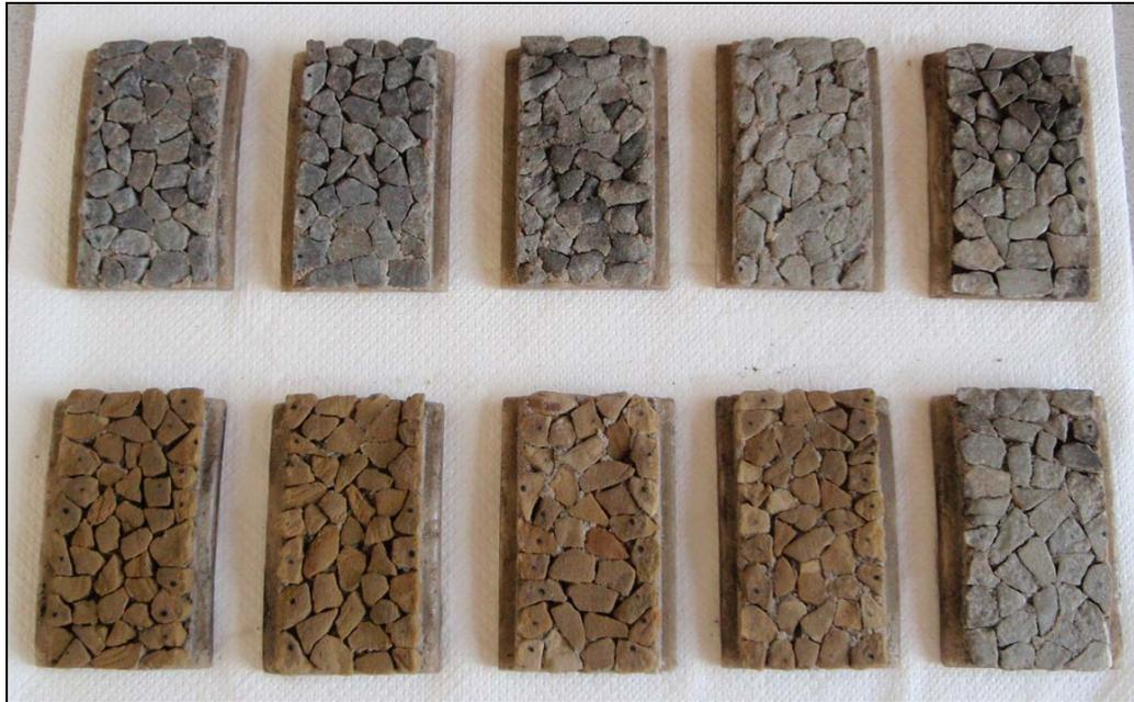
Abb. 5.40: PSV-Probekörper nach der Prüfung
