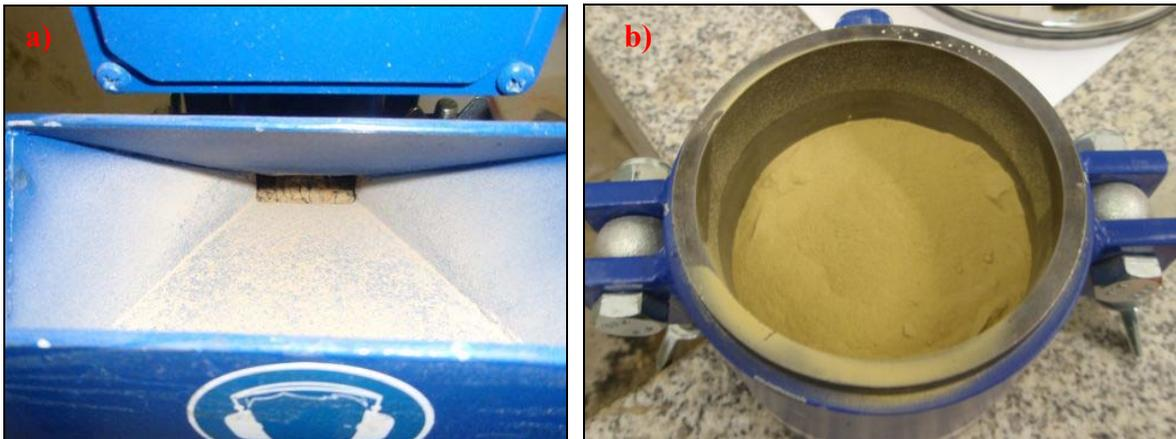
Abb.4.20 a) Probe wird über die Rampe in den Behälter geleert
