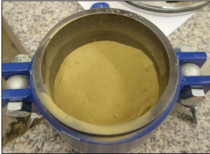
Abb. 6.9: Probe K4 („weicher“ Sandstein) aus Klosterneuburg nach dem LCPC-Test trocken.
