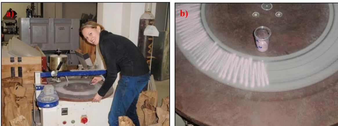
Abb. 4.11 a) und b) gleichmäßiges Auftragen des künstlichen Korunds
