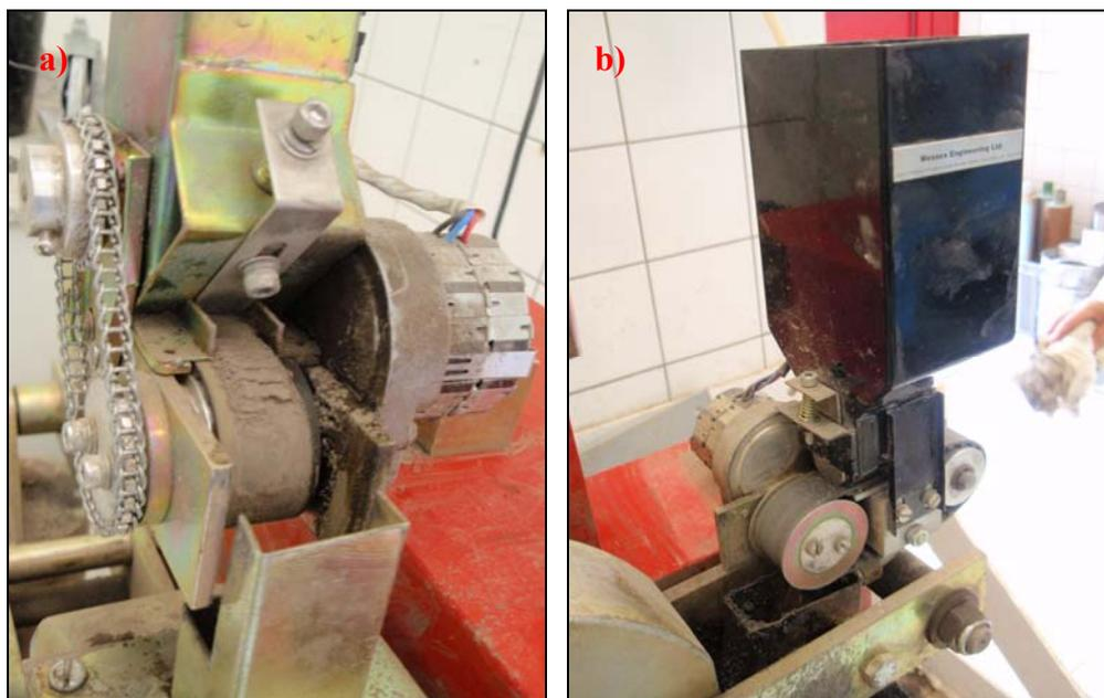
Abb. 4.7 a) und b) Die Zugabe des Abrasivmittels (Korund) während des Betriebs der Schnellpoliermaschine.
