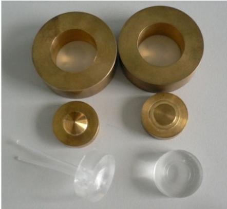
Abbildung 24: Messingvorlage für die Silikonmesszelle.
