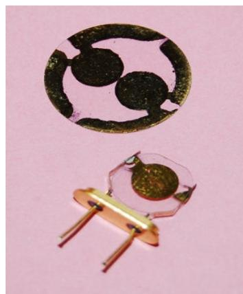
**Abbildung 9:** Vergleich von kommerziell erhältlichem Schwingquarz mit aufgedampften Goldelektroden mit dem verwendeten Quarz. Beide Quarze weisen Resonanzfrequenz von 10 MHz auf.
