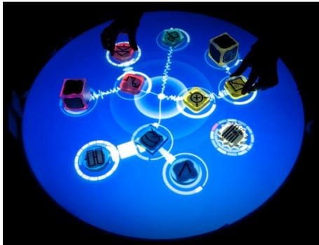
Abb. 13 – Reactable: Ein Tisch mit grafischer Multi-Touch-Oberfläche und symbolischen Bausteinen, die von einem Kamera-System erfasst werden, miteinander musikalisch interagieren und von mehreren Benutzern gesteuert werden können. (Abb.: REACTABLE SYSTEMS, 2010)
