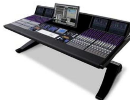
Abb. 8 – Euphonix System 5-MC: Ein einer großen Mischkonsole nachempfunderer DAW-Controller mit mehreren Bildschirmen, Tastatur, Trackball und detaillierter Beleuchtung. (Abb.: aus Euphonix, 2009)
