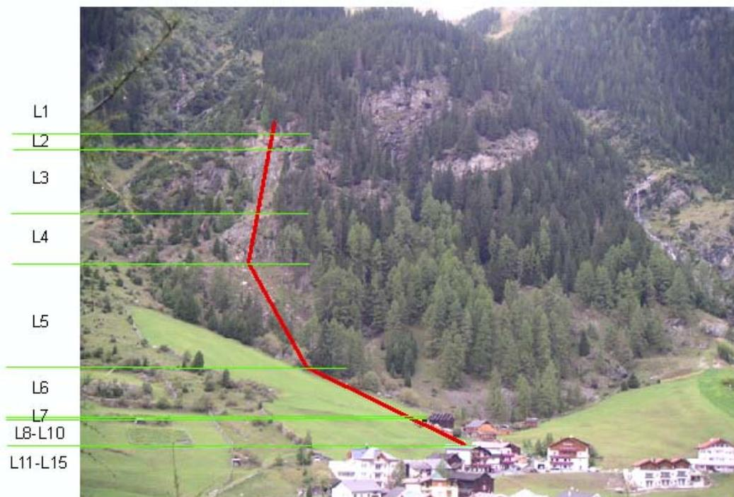
Abbildung 7-4: Mögliche Sturzbahn Versahl A
