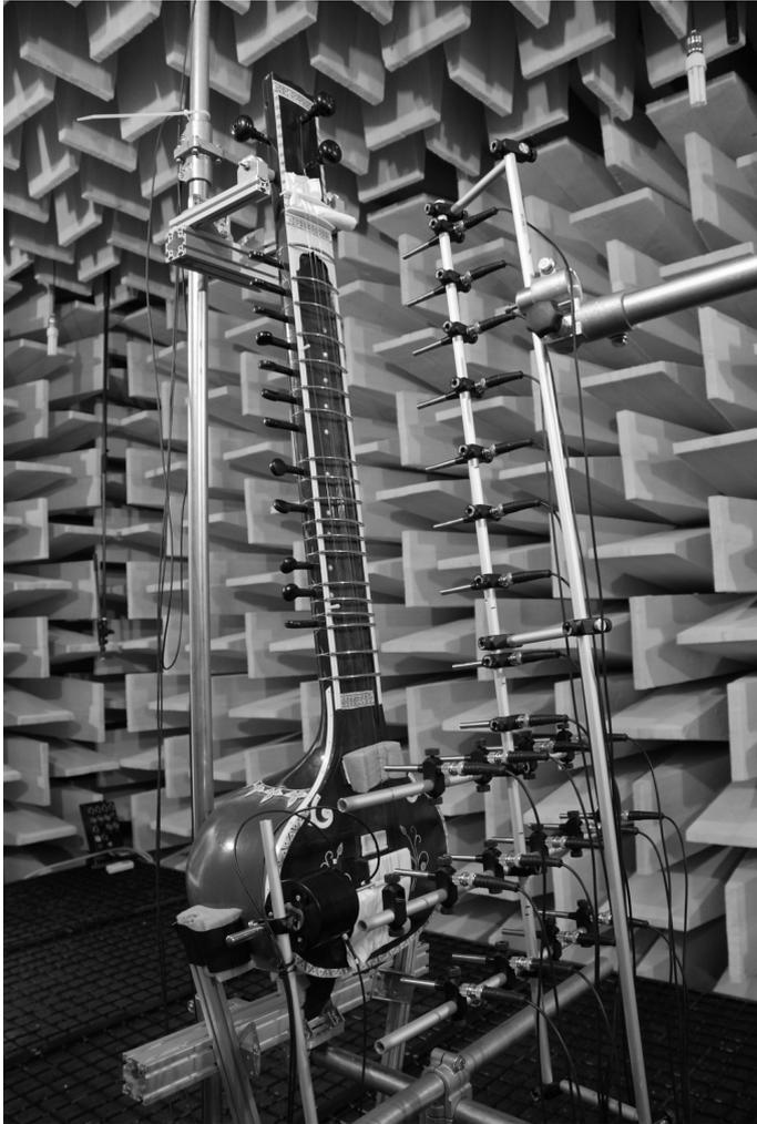
**Abbildung 5.1:** Der Aufbau der Messung (ohne die Mikrofone hinter dem Resonanzkörper).
