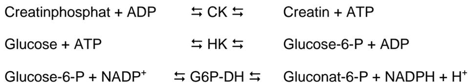
Bezogen auf äquimolare Mengen verläuft die Bildung von NADPH und ATP mit der gleichen Geschwindigkeit. Die Geschwindigkeit der photometrisch gemessenen NADPH-Bildung ist direkt proportional zu der CK-Aktivität. (laut Beipackzettel für CK der Firma Roche/ Hitachi)
