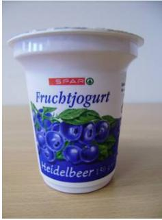
Das Prüfmuster 14 mit der Bezeichnung „SPAR Fruchtojoghurt Heidelbeer“ besteht aus einem konisch geformten, vollflächig bedruckten Kunststoffbecher aus PS. Als Deckel dient eine peelfähige, bedruckte und geprägte Aluminiumplatte mit Öffnungslasche und einem Durchmesser von 75,5 mm.
