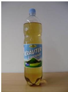
Das Prüfmuster 29 mit der Bezeichnung „Goldana Kräuter Limonade light“ mit Originalitätsverschluss und Kunststoffbänderole ist gekennzeichnet durch durchgehende, wellenförmige Versteifungen im unteren Drittel der Seitenwand, eine Griffmulde mit durchgehenden horizontalen Versteifungen im oberen Drittel des Flaschenkörpers sowie einen Petaloidboden.
