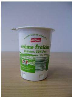
Das Prüfmuster 08 mit der Bezeichnung „milfina crème fraîche Kräuter 32 % Fett“ besteht aus einem zylindrisch geformten, vollflächig bedruckten Kunststoffbecher aus PP. Als Deckel wird eine peelfähige, bedruckte und glatte Aluminiumplatte mit Öffnungslasche und einem Durchmesser von 70 mm eingesetzt.
