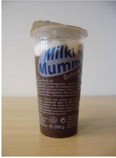
Das Prüfmuster 29 mit der Bezeichnung „Milki Mumm Schoko“ besteht aus einem konisch geformten, transparenten und zum Teil bedruckten Kunststoffbecher aus PP. Als Deckel findet eine peelfähige, bedruckte und geprägte Aluminiumplatte mit Öffnungs- lasche und einem Durchmesser von 70 mm Anwendung.
