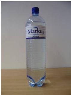
Das Prüfmuster 32 mit der Bezeichnung „Markus Quelle PRICKELND“ mit Originalitätsverschluss, Papierbänderole und Petaloidboden ist gekennzeichnet durch eine gerade Flaschenform und eine durchgehende, horizontale Rippenstruktur im unteren Bereich der Seitenwand sowie eine horizontale und mehrere vertikale Versteifungen an der Schulter.
