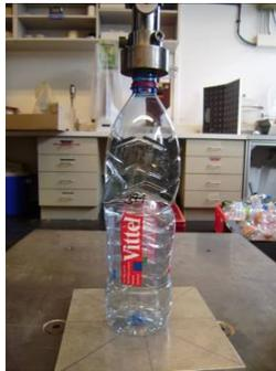
Abbildung 94: Axialdruckfestigkeit – Einknicken der Probe
