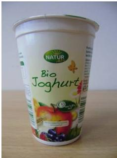
Bei dem Prüfmuster 31 mit der Bezeichnung „NATUR aktiv Bio Joghurt Apfel-Birne mit Müsli“ handelt es sich um einen voll- flächig bedruckten K3-Verbundbecher mit einem Innenbecher aus PS. Als Deckel dient eine peelfähige, bedruckte und glatte Alu- miniumplatte mit Öffnungs- lasche und einem Durchmesser von 75,5 mm.
