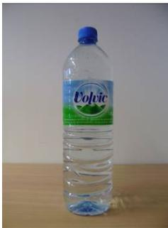
Das Prüfmuster 40 mit der Bezeichnung „Volvic naturell“ mit Originalitätsverschluss und Kunststoffbanderole besitzt eine gerade Flaschenform mit quadratischer Basis sowie einen Stillwasserboden und weist auf der kompletten Seitenwand eine durchgehende, teils horizontale, teils wellenförmige Rippenstruktur auf.
