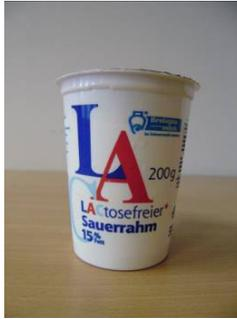
Das Prüfmuster 25 mit der Bezeichnung „LA LACTosefreier Sauerrahm 15 % Fett“ besteht aus einem konisch geformten, vollständig bedruckten Kunststoffbecher aus PS. Als Deckel wird eine peelfähige, bedruckte und glatte Aluminiumplatte mit Öffnungslasche und einem Durchmesser von 75,5 mm verwendet.
