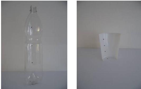
**Abbildung 92: Dicke – Verteilung der Messpunkte bei PET-Flasche (links)**
