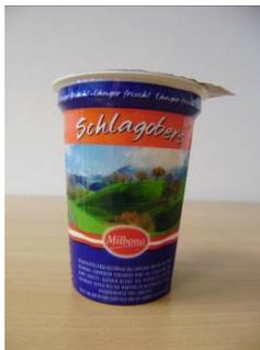
Das Prüfmuster 27 mit der Bezeichnung „Milbona Schlagobers“ besteht aus einem konisch geformten Kunststoffbecher aus PS, welcher von einem Sleeve umgeben ist. Als Deckel wird eine peelfähige, bedruckte und glatte Aluminiumplatte mit Öffnungslasche und einem Durchmesser von 75,5 mm eingesetzt.
