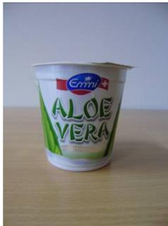
Bei dem Prüfmuster 03 mit der Bezeichnung „Emmi ALOE VERA“ handelt es sich um einen vollflächig bedruckten K3-Verbundbecher mit einem Innenbecher aus PS. Eine peelfähige, bedruckte und glatte Platine aus Aluminium-Kunststoff-Verbund mit Öffnungslasche und einem Durchmesser von 75,5 mm findet als Deckel Verwendung.
