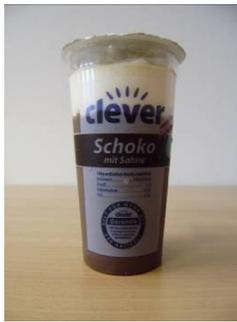
Das Prüfmuster 18 mit der Bezeichnung „clever Schoko“ besteht aus einem konisch geformten, transparenten und zum Teil bedruckten Kunststoffbecher aus PP. Eine peelfähige, bedruckte und geprägte Aluminiumplatte mit Öffnungsglasche und einem Durchmesser von 70 mm wird als Deckel verwendet.
