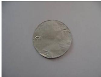
**Abbildung 91: Masse – Ausgestanzter Probenkörper mit einer Fläche von 1.538,9 mm<sup>2</sup>**
