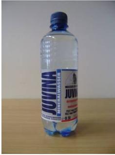
Das Prüfmuster 08 mit der Bezeichnung „JUVINA prickelnd“ mit Originalitätsverschluss und Papierbanderole wird charakterisiert durch horizontale Versteifungen mit Rippenstruktur im oberen und unteren Drittel der Seitenwand, die Logoprägung „J“ im Schulterbereich und einen Petaloidboden bei einer geraden Flaschenform.
