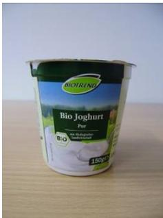
Bei dem Prüfmuster 01 mit der Bezeichnung „BIOTREND Bio Joghurt pur“ handelt es sich um einen K3-Verbundbecher mit einem Innenbecher aus dem Werkstoff PS. Als Deckel dient eine peelfähige, bedruckte und glatte Aluminiumplatine mit Öffnungslasche und einem Durchmesser von 75,5 mm.
