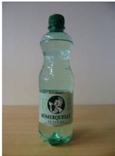
Das Prüfmuster 13 mit der Bezeichnung „RÖMERQUELLE prickelnd“ mit Originalitätsverschluss, Kunststoffbanderole und Petaloidboden besitzt im unteren Drittel der Seitenwand unterbrochene horizontale Versteifungen und im oberen Drittel eine Griffmulde mit durchgehenden, wellenförmigen Versteifungen.
