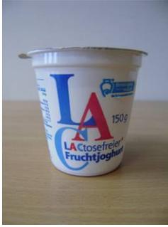
Das Prüfmuster 06 mit der Bezeichnung „LA LACTosefreier Fruchtojoghurt Vanille“ besteht aus einem konisch geformten, vollflächig bedruckten Kunststoffbecher aus PS. Als Deckel dient eine peelfähige, bedruckte und glatte Aluminiumplatte mit Öffnungslasche und einem Durchmesser von 75,5 mm.
