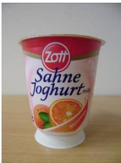
Bei dem Prüfmuster 17 mit der Bezeichnung „Zott Sahne Joghurt Blutorange“ handelt es sich um einen konisch geformten Kunststoffbecher aus PP mit Bodensockel und Kunststoffetikette. Als Deckel wird eine peelfähige, bedruckte und geprägte Aluminiumplatte mit Öffnungslasche und einem Durchmesser von 75,5 mm verwendet.
