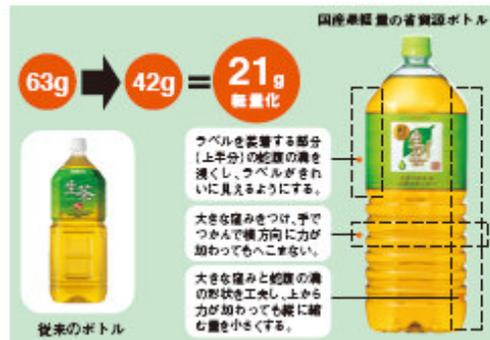
Abbildung 1: Pecology Bottle für Nama-cha, Kirin Beverage Co., Ltd. - vor bzw. nach der Materialreduktion (v. l. n. r.) [Quelle: KIRIN BEVERAGE CO., LTD.]
