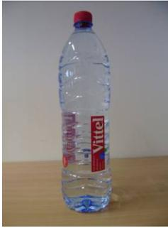
Das Prüfmuster 39 mit der Bezeichnung „Vittel“ mit Originalitätsverschluss, Kunststoffbanderole und Stillwasserboden ist gekennzeichnet durch eine gerade Flaschenform, ein Shorty-Mundstück, eine durchgehende, wellenförmige Rippenstruktur an der unteren Hälfte der Seitenwand sowie isoliert angeordnete, wellenförmige Versteifungen in der oberen Flaschenhälfte.
