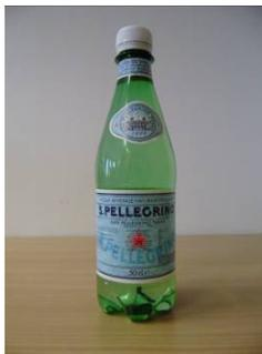
Das Prüfmuster 14 mit der Bezeichnung „S. PELLEGRINO“ mit Originalitätsverschluss, Papierbanderole und -etikette ist gekennzeichnet durch eine gerade Flaschenform mit einem konisch zulaufenden Halsbereich und einen Petaloidboden. In der unteren Hälfte der Seitenwand befinden sich durchgehende, horizontale Versteifungen.
