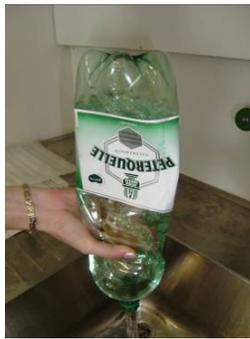
**Abbildung 88: Ausschenkverhalten – starkes, gleichmäßiges Zusammenziehen des Flaschenkörpers**
