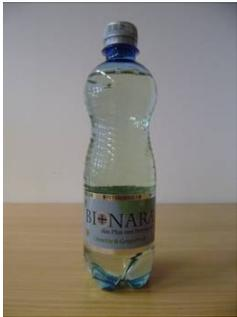
Charakteristisch für das Prüfmuster 02 mit der Bezeichnung „BIONARA Limette & Grapefruit“ mit Originalitätsverschluss, Papierbanderole und Petaloidboden sind die Griffmulde mit schräg verlaufenden Versteifungen im oberen Flaschenbereich sowie die durchgehenden, horizontalen Versteifungen im unteren Drittel der Seitenwand.
