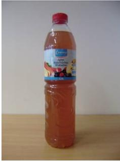
Bei dem Prüfmuster 31 mit der Bezeichnung „Linessa vital & active Apfel-Rote Früchte-Rhabarber“ mit Originalitätsverschluss, Kunststoffbänderole und Stillwasserboden handelt es sich um eine Weithalsflasche mit der Logoprägung „SOLEVITA“ im Schulterbereich und horizontaler bzw. wellenförmiger Rippenstruktur sowie Dickstellen auf der kompletten Seitenwand.
