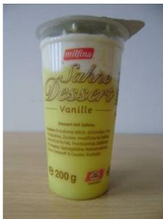
Bei dem Prüfmuster 28 mit der Bezeichnung „milfina Sahne Dessert Vanille“ handelt es sich um einen konisch geformten, transparenten und zum Teil bedruckten Kunststoffbecher aus PP. Eine peelfähige, bedruckte und geprägte Aluminiumplatte mit Öffnungslasche und einem Durchmesser von 70 mm dient als Deckel.
