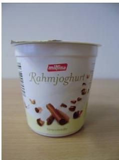
Bei dem Prüfmuster 09 mit der Bezeichnung „milfina Rahmjoghurt Stracciatella“ handelt es sich um einen vollflächig bedruckten K3-Verbundbecher mit einem Innenbecher aus PS. Als Deckel fungiert eine peelfähige, bedruckte und glatte Aluminiumplatte mit Öffnungslasche und einem Durchmesser von 75,5 mm.
