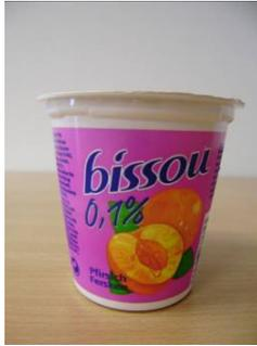
Das Prüfmuster 02 mit der Bezeichnung „bissou 0,1 % Pfirsich“ besteht aus einem konisch geformten, vollflächig bedruckten Kunststoffbecher aus PS. Als Deckel fungiert eine peelfähige, bedruckte und glatte Aluminiumplatte mit Öffnungslasche und einem Durchmesser von 75,5 mm.
