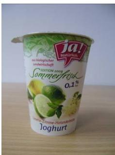
Bei dem Prüfmuster 24 mit der Bezeichnung „ja! Natürlich Joghurt Sommerfrisch 0,1 % Fett Limette-Zitrone-Holunderblüte“ findet ein vollflächig bedruckter K3-Verbundbecher mit einem Innenbecher aus PS Verwendung. Eine peelfähige, bedruckte und glatte Aluminiumplatte mit Öffnungslasche und einem Durchmesser von 75,5 mm fungiert als Deckel.
