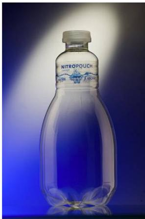
Teil, in dem sich der Großteil des Füllgutes befindet, ist der Durchmesser merklich erhöht. Aufgrund der Anwendung eines Blasmaschinen-Füller-Blocks kann der Tragring weggelassen werden, was eine zusätzliche Materialeinsparung bedeutet. Zum Erhalt der Stabilität bei Transport und Handling wird die Flasche mit Stickstoff beaufschlagt. PET lite 6.6 hat die ersten Praxistests erfolgreich absolviert, es laufen Gespräche mit potentiellen Abnehmern [MONTAGUE-JONES, 2009], [KRONES].
