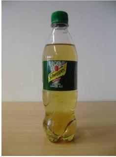
Das Prüfmuster 16 mit der Bezeichnung „Schweppes GINGER ALE“ mit Originalitätsverschluss und Kunststoffbänderole besitzt eine gerade Flaschenform und einen Petaloidboden. Im oberen Drittel der Seitenwand befinden sich eine durchgehende, horizontale, im unteren Drittel eine durchgehende, geschwungene Versteifung, im Schulterbereich die Logoprägung „Schweppes“.
