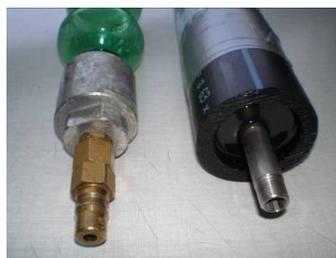
**Abbildung 95: Berstdruck - Schraubadapter nach DIN 53758-1975, gefertigter Adapter (v. l. n. r.)**
