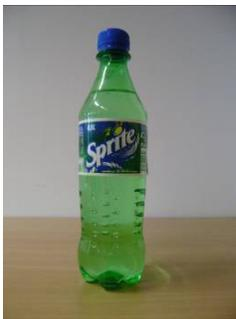
Charakteristisch für das Prüfmuster 18 mit der Bezeichnung „Sprite“ mit Originalitätsverschluss und Kunststoffbänderole sind der Petaloidboden, die gerade Flaschenform mit einem konisch zulaufenden Halsbereich und die noppenförmigen Versteifungen in der unteren Hälfte der Seitenwand.
