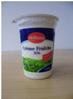
Bei dem Prüfmuster 26 mit der Bezeichnung „Milbona Crème Fraîche 30 %“ handelt es sich um einen konisch geformten, vollständig bedruckten Kunststoffbecher aus PS. Als Deckel dient eine peelfähige, bedruckte und geprägte Aluminiumplatte mit Öffnungslasche und einem Durchmesser von 75,5 mm.
