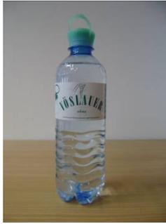
Das Prüfmuster 20 mit der Bezeichnung „VÖSLAUER pocket ohne“ mit Originalitätsverschluss, Papierbanderole und Petaloidboden besitzt durchgehende, wellenförmige Versteifungen im unteren und unterbrochene, horizontale Versteifungen im oberen Drittel der Seitenwand sowie die Logoprägung „VÖSLAUER“ im Schulterbereich.
