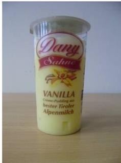
Bei dem Prüfmuster 19 mit der Bezeichnung „Dany Sahne VANILLA“ handelt es sich um einen konisch geformten, transparenten und zum Teil bedruckten Kunststoffbecher aus PP. Als Deckel fungiert eine peelfähige, bedruckte und geprägte Aluminiumplatte mit Öffnungsglasche und einem Durchmesser von 70 mm.
