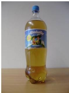
Das Prüfmuster 21 mit der Bezeichnung „Almdudler zuckerfrei“ mit Originalitätsverschluss und Kunststoffbanderole besitzt im oberen und unteren Drittel der Seitenwand eine durchgehende, horizontale Versteifung mit Punktmuster, im Mittelbereich eine durchgehende, horizontale Versteifung sowie einen Petaloidboden.
