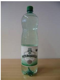
Das Prüfmuster 33 mit der Bezeichnung „PETERQUELLE NATURFRISCH“ mit Originalitätsverschluss und Papierbänderole weist im unteren Drittel der Seitenwand eine durchgehende, horizontale Versteifung und im oberen Drittel eine Griffmulde mit durchgehenden, wellenförmigen Versteifungen auf und besitzt einen Petaloidboden.
