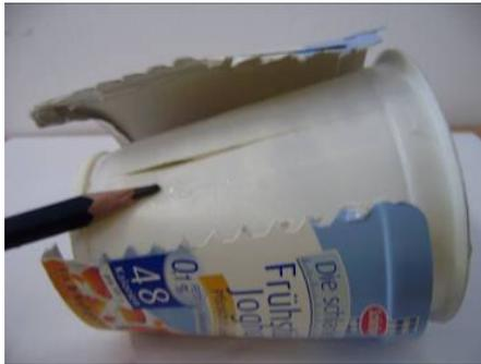
**Abbildung 98: Bruchfallhöhe – Bruch im Bereich der Seitenwand (links)**
