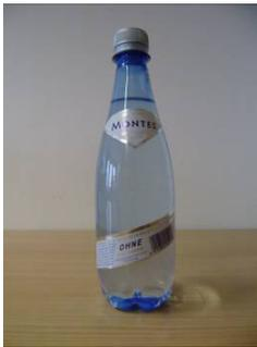
Das Prüfmuster 09 mit der Bezeichnung „MONTES OHNE“ mit Originalitätsverschluss, Papieretikette und Petaloidboden ist gekennzeichnet durch eine gerade Flaschenform mit einem konisch zulaufenden Halsbereich und eine Seitenwand ohne Versteifungen.
