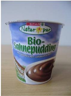
Bei dem Prüfmuster 15 mit der Bezeichnung „SPAR Natur pur Bio-Sahnepudding Schoko“ findet ein vollflächig bedruckter K3-Verbundbecher mit einem Innenbecher aus PP Verwendung. Als Deckel fungiert eine peelfähige, bedruckte und glatte Aluminiumplatte mit Öffnungslasche und einem Durchmesser von 75,5 mm.
