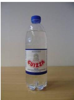
Das Prüfmuster 07 mit der Bezeichnung „GUIZZA FRIZZANTE“ mit Originalitätsverschluss, Kunststoffbanderole und Petaloidboden ist gekennzeichnet durch eine gerade Flaschenform und ein Shorty-Mundstück sowie durchgehende, horizontale Versteifungen in den unteren zwei Drittel der Seitenwand und unterbrochene, schräge Versteifungen im Schulterbereich.
