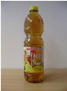
Bei dem Prüfmuster 24 mit der Bezeichnung „DESPAR Ice tea Limone“ mit Originalitätsverschluss, beschichteter Papierbänderole und Stillwasserboden handelt es sich um eine Weithalsflasche mit Griffmulde sowie durchgehenden, horizontalen Versteifungen im unteren sowie schräg angeordnete Versteifungen im oberen Flaschenbereich.
