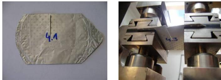
**Abbildung 100: Weiterreißfestigkeit – Probenkörper mit definiertem Einschnitt (links)**
