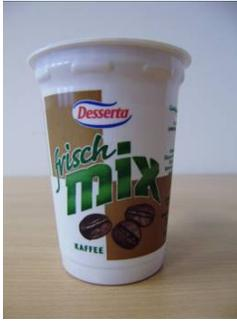
Bei dem Prüfmuster 21 mit der Bezeichnung „Desserta frisch mix KAFFEE“ handelt es sich um einen konisch geformten, vollflächig bedruckten Kunststoffbecher aus PS. Als Deckel dient eine peelfähige, bedruckte und glatte Aluminiumplatte mit Öffnungslasche und einem Durchmesser von 75,5 mm.
