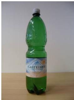
Das Prüfmuster 28 mit der Bezeichnung „GASTEINER kristallklar NATUR“ mit Originalitätsverschluss, Papierbänderole und Petaloidboden besitzt im unteren Drittel der Seitenwand durchgehende, horizontale und im Schulterbereich vertikale sowie karoförmige Versteifungen sowie im Mittelbereich der Flasche eine Griffmulde mit schräg angeordneten Versteifungen.
