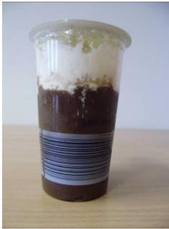
Bei dem Prüfmuster 30 mit der Bezeichnung „Monte Ravy Schoko“ handelt es sich um einen konisch geformten, transparenten und zum Teil bedruckten Kunststoffbecher aus PP. Eine peelfähige, bedruckte und geprägte Aluminiumplatte mit Öffnungs- lasche und einem Durchmesser von 75,5 mm fungiert als Deckel.
