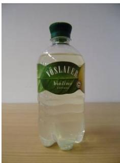
Das Prüfmuster 19 mit der Bezeichnung „VÖSLAUER biolimo zitrone“ mit Originalitätsverschluss und Papierbänderole besitzt in der unteren Hälfte der Seitenwand durchgehende, wellenförmige und im oberen Flaschenbereich unterbrochene, horizontale Versteifungen, im Schulterbereich die Logoprägung „VÖSLAUER“ sowie einen Petaloidboden.
