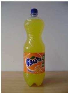
Das Prüfmuster 25 mit der Bezeichnung „Fanta“ mit Originalitätsverschluss und Kunststoffbänderole weist eine Griffmulde mit noppenförmigen Versteifungen im oberen Drittel der Seitenwand und horizontale Versteifungen in Noppenform im unteren Drittel des Flaschenkörpers sowie einen Petaloidboden auf.
