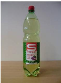
Das Prüfmuster 38 mit der Bezeichnung „SBUDGET AQUA+ Jostabeere“ mit Originalitätsverschluss und Papierbanderole besitzt im unteren Drittel der Seitenwand eine durchgehende, horizontale Versteifung, im oberen Drittel eine Griffmulde mit horizontalen Versteifungen sowie einen Petaloidboden.
