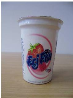
Bei dem Prüfmuster 23 mit der Bezeichnung „Fri Fru Sauermilch mit Waldbeeren“ handelt es sich um einen konisch geformten Kunststoffbecher aus PS, der von einem Sleeve umgeben ist. Als Deckel findet eine peelfähige, bedruckte und glatte Aluminiumplatte mit Öffnungslasche und einem Durchmesser von 75,5 mm Anwendung.
