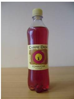
Das Prüfmuster 03 mit der Bezeichnung „CARPE DIEM KOMBUCHA CLASSIC“ mit Originalitätsverschluss und Kunststoffbanderole ist gekennzeichnet durch eine gerade Flaschenform, einen Petaloidboden und eine durchgehende, horizontale Versteifung im mittleren Bereich der Seitenwand.
