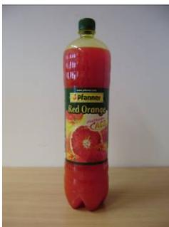
Das Prüfmuster 34 mit der Bezeichnung „Pfanner plus Vitamine ACE Red Orange“ mit Originalitätsverschluss und Kunststoffbänderole wird charakterisiert durch eine gerade Flaschenform, durchgehende, horizontale Versteifungen mit Rippenstruktur auf der kompletten Seitenwand sowie einen Petaloidboden.
