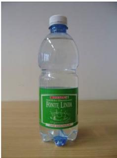
Charakteristisch für das Prüfmuster 05 mit der Bezeichnung „DESPAR Natürliches Mineralwasser FONTE LINDA“ mit Originalitätsverschluss und Kunststoffbanderole sind durchgehende, horizontale Versteifungen in der unteren Hälfte der Seitenwand, eine Griffmulde im oberen Flaschenbereich und ein Petaloidboden.
