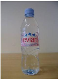
Das Prüfmuster 06 mit der Bezeichnung „evian Acqua Minerale Naturale“ mit Originalitätsverschluss, Kunststoffbanderole und Stillwasserboden besitzt wellenförmige und ovale Versteifungen im unteren sowie horizontale Versteifungen im mittleren Bereich und Versteifungen in Form einer Gebirgskette an der Schulter bei einer geraden Flaschenform und einem Shorty-Mundstück.
