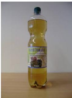
Das Prüfmuster 26 mit der Bezeichnung „FRANKENMARKTER Kräuter Kalorienarm & Zuckerfrei“ mit Originalitätsverschluss, Papierbänderole und Petaloidboden besitzt im oberen sowie unteren Drittel der Seitenwand durchgehende, horizontale Versteifungen und im oberen Drittel eine Griffmulde ebenfalls mit durchgehenden, horizontalen Versteifungen.
