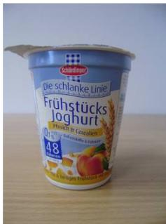
Das Prüfmuster 12 mit der Bezeichnung „Schäringer Die schlanke Linie Frühstück Joghurt Pfirsich & Cerealien“ besteht aus einem vollflächig bedruckten K3-Verbundbecher mit einem Innenbecher aus PS. Als Deckel fungiert eine peelfähige, bedruckte und glatte Aluminiumplatte mit Öffnungslasche und einem Durchmesser von 75,5 mm.
