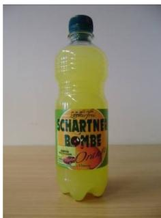
Das Prüfmuster 15 mit der Bezeichnung „SCHARTNER BOMBE Orange“ mit Originalitätsverschluss und Papierbanderole besitzt im unteren Drittel der Seitenwand eine durchgehende, horizontale Versteifung, im oberen Drittel eine Griffmulde mit durchgehenden, horizontalen Versteifungen und einen Petaloidboden.
