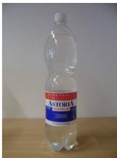
Das Prüfmuster 29 mit der Bezeichnung „ASTORIA PRICKELND“ mit Originalitätsverschluss, Kunststoffbanderole und Petaloidboden ist gekennzeichnet durch durchgehende, wellenförmige Versteifungen im oberen und unteren Bereich der Flaschenwand und eine Griffmulde mit durchgehenden, horizontalen Versteifungen im oberen Drittel der Seitenwand.
