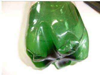
**Abbildung 87: Sichtbare Fehler – Deformation des Petaloidbodens**
