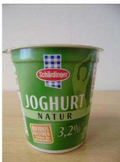
Bei dem Prüfmuster 13 mit der Bezeichnung „Schäringer JOGHURT NATUR 3,2 %“ handelt es sich um einen bedruckten K3-Verbundbecher mit einem Innenbecher aus PS. Eine peelfähige, bedruckte und glatte Aluminiumplatte mit Öffnungslasche und einem Durchmesser von 75,5 mm wird als Deckel verwendet.
