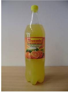
Charakteristisch für das Prüfmuster 27 mit der Bezeichnung „Frucade Orangenfruchtsaft-Limonade“ mit Originalitätsverschluss und Kunststoffbänderole sind die schräg angeordneten Versteifungen im oberen sowie unteren Drittel der Seitenwand, die unterbrochenen, horizontalen Versteifungen im Mittelbereich des Flaschenkörpers und der Petaloidboden.
