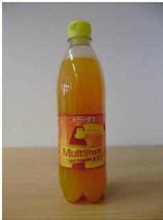
Das Prüfmuster 17 mit der Bezeichnung „SPAR Multifrukt ACE“, mit Originalitätsverschluss und Kunststoffbänderole ist gekennzeichnet durch eine gerade Flaschenform mit glatter Seitenwand ohne Versteifungen sowie einen Petaloidboden.
