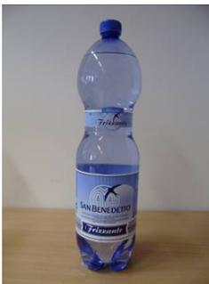
Das Prüfmuster 37 mit der Bezeichnung „SAN BENEDETTO Frizzante“ mit Originalitätsverschluss, Papierbanderole und -etikette ist gekennzeichnet durch eine durchgehende, horizontale Versteifung in der unteren Hälfte der Seitenwand, eine Griffmulde mit horizontaler Versteifung im oberen Flaschenbereich, einen Petaloidboden und ein Shorty-Mundstück.
