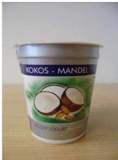
Bei dem Prüfmuster 11 mit der Bezeichnung „SalzburgerLand DESSERTJOGHURT KOKOS-MANDEL“ findet ein vollflächig bedruckter K3-Verbundbecher mit einem Innenbecher aus PS Verwendung. Als Deckel dient eine peelfähige, bedruckte und glatte Aluminiumplatte mit Öffnungslasche und einem Durchmesser von 75,5 mm.
