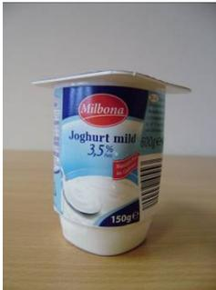
Bei dem Prüfmuster 07 mit der Bezeichnung „Milbona Joghurt mild 3,5 %“ handelt es sich um einen zylindrisch geformten Kunststoffbecher aus PS mit Kunststoffbanderole, welcher ein Bestandteil einer Vierer-Multipack-Einheit ist. Eine peelfähige, bedruckte Verbundfolie mit einer Seitenlänge von 65 mm wird als Deckel verwendet.
