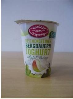
Bei dem Prüfmuster 37 mit der Bezeichnung „zurück zum Ursprung REICHENSTEINER BERGBAUERN JOGHURT Apfe-Birne“ handelt es sich um einen vollflächig bedruckten K3-Verbundbecher mit einem Innenbecher aus PS. Eine peelfähige, bedruckte und glatte Aluminiumplatte mit Öffnungslasche und einem Durchmesser von 75,5 mm dient als Deckel.
