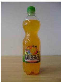
Das Prüfmuster 11 mit der Bezeichnung „RADLBERGER Orange zuckerfrei“ mit Originalitätsverschluss, Kunststoffbanderole und Petaloidboden besitzt eine Griffmulde mit schräg verlaufenden Versteifungen im oberen Bereich des Flaschenkörpers sowie eine durchgehende, horizontale Versteifung im unteren Drittel der Seitenwand.
