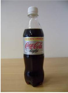
Das Prüfmuster 04 mit der Bezeichnung „Coca Cola light“ mit Originalitätsverschluss, Kunststoffbanderole und Petaloidboden besitzt im oberen und im unteren Drittel der Seitenwand vertikale Versteifungen.
