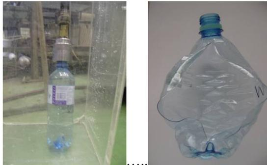
**Abbildung 96: Berstdruck – Durchführung des Versuches (links)**
