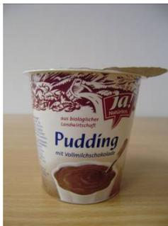
Das Prüfmuster 04 mit der Bezeichnung „ja! Natürlich Pudding mit Vollmilchschokolade“ besteht aus einem vollflächig bedruckten K3-Verbundbecher mit einem Innenbecher aus PP. Als Deckel dient eine peelfähige, bedruckte und glatte Aluminiumplatte mit Öffnungslasche und einem Durchmesser von 75,5 mm.
