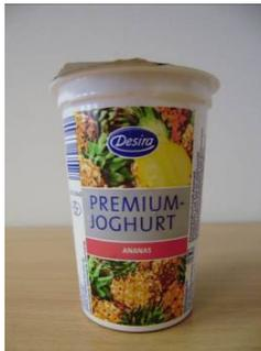
Das Prüfmuster 20 mit der Bezeichnung „Desira PREMIUM-JOGHURT ANANAS“ besteht aus einem konisch geformten, vollflächig bedruckten Kunststoffbecher aus PP. Als Deckel findet eine peelfähige, bedruckte und glatte Aluminiumplatte mit Öffnungsglasche und einem Durchmesser von 75,5 mm Anwendung.
