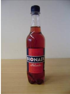
Das Prüfmuster 01 mit der Bezeichnung „BIONADE Holunder“ mit Originalitätsverschluss, beschichteter Papierbanderole und Petaloidboden besitzt einen überdurchschnittlich langen Halsbereich bei einer gerade Flaschenform. Im unteren Drittel der Seitenwand befindet sich eine durchgehende, horizontale Versteifung, im Halsbereich die Logoprägung „BIONADE“.
