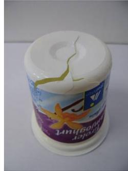
**Abbildung 99: Bruchfallhöhe – Bruch im Bereich des Becherbodens und der Seitenwand (rechts)**
