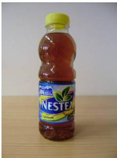
Bei dem Prüfmuster 10 mit der Bezeichnung „NESTEA Lemon“ mit Originalitätsverschluss, Kunststoffbanderole und Stillwasserboden handelt es sich um eine Weithalsflasche mit durchgehenden, horizontalen Versteifungen in der unteren Hälfte der Seitenwand sowie eine Griffmulde und Versteifungen in Blattform im oberen Flaschendrittel.
