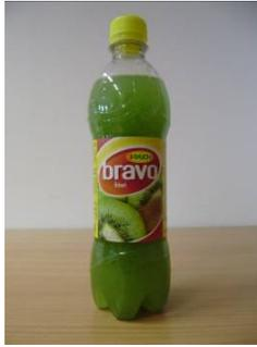
Das Prüfmuster 12 mit der Bezeichnung „RAUCH bravo kiwi“ mit Originalitätsverschluss, Papierbanderole und Petaloidboden ist gekennzeichnet durch eine gerade Flaschenform. In den unteren zwei Drittel der Seitenwand befinden sich zum Teil durchgehende, zum Teil unterbrochene, wellenförmige Versteifungen und im Schulterbereich die Logoprägung „RAUCH“.
