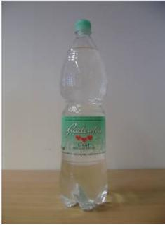
Das Prüfmuster 35 mit der Bezeichnung „Radenska LIGHT“ mit Originalitätsverschluss, Kunststoffbanderole und Petaloidboden besitzt im oberen und unteren Drittel der Seitenwand eine durchgehende, horizontale bzw. wellenförmige Rippenstruktur und im Mittelbereich eine Griffmulde mit schräg angeordneter Versteifung.
