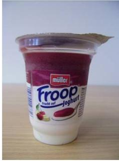
Das Prüfmuster 10 mit der Bezeichnung „müller Froop Frucht auf Joghurt Kirsch“ besteht aus einem konisch geformten Kunststoffbecher aus PP mit Kunststoffetikette. Eine peelfähige, bedruckte und glatte Aluminiumplatte mit Öffnungslasche und einem Durchmesser von 75,5 mm wird als Deckel verwendet.
