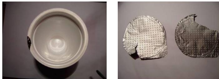
**Abbildung 89: Abziehen der Platine – Rückstand am Becherrand (links)**
