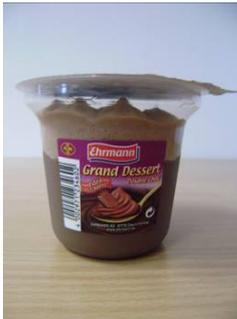
Das Prüfmuster 22 mit der Bezeichnung „Ehrmann Grand Dessert Double Choc“ besteht aus einem konisch geformten, transparenten Kunststoffbecher aus PP mit Papieretikette. Eine peelfähige, bedruckte und glatte Aluminiumplatte mit Öffnungslasche und einem Durchmesser von 95 mm wird als Deckel verwendet.
