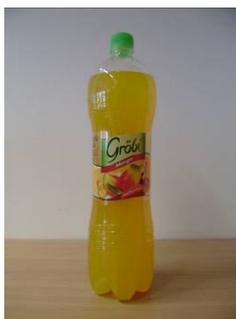
Das Prüfmuster 30 mit der Bezeichnung „Gröbi zuckerfrei Mango“ mit Originalitätsverschluss, Kunststoffbänderole und Petaloidboden weist im oberen sowie unteren Drittel der Seitenwand durchgehende, noppenförmige und im Mittelbereich unterbrochene, horizontale Versteifungen auf.
