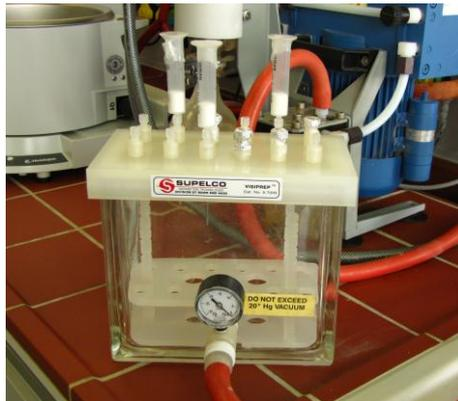
**Abbildung 5: Vakuumkammer mit SPE-Kartuschen**
