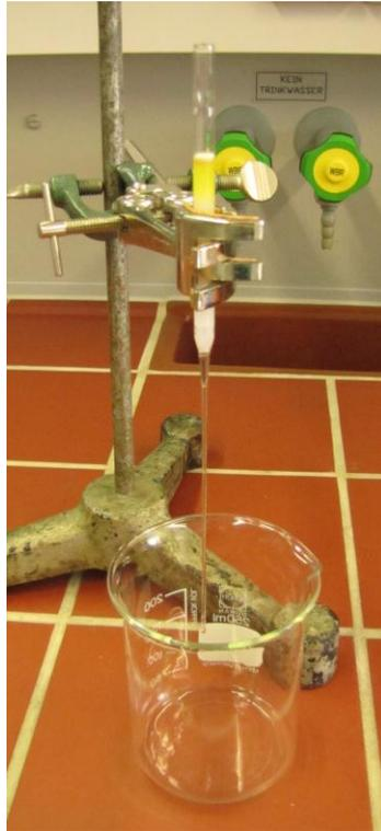
**Abbildung 20: Säulenchromatographische Aufreinigung von BK1 an Sephadex LH-20 im Miniaturmaßstab**
