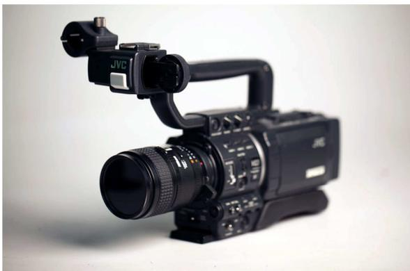
**Abb. 10:** JVC GY-HD 111 mit aufgesetztem Nikon 85mm Makro Objektiv
