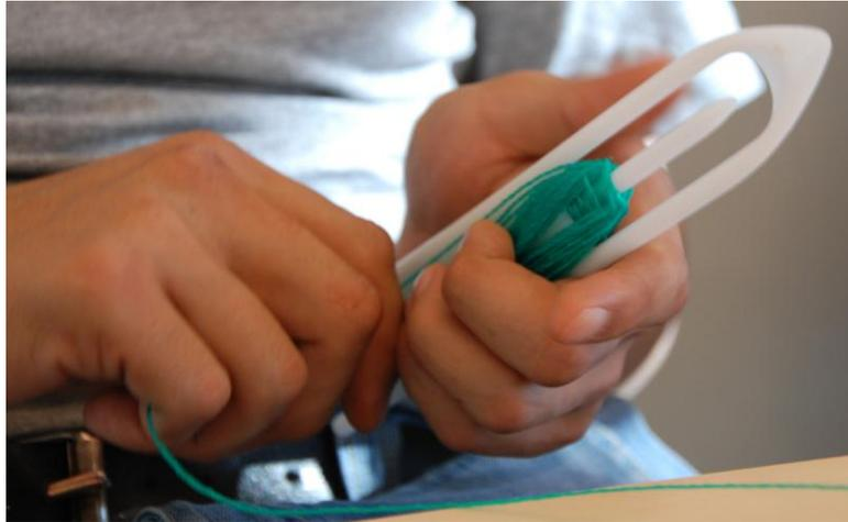
**Abbildung 6: Die Netznadel wird bewickelt (Foto AK)**
