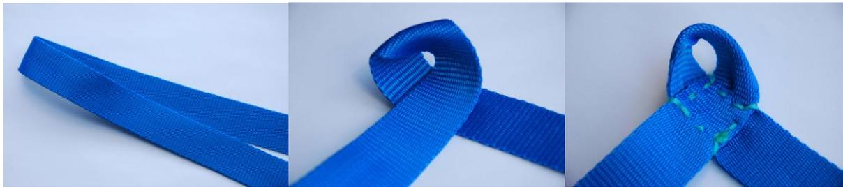
**Abbildung 34: a), b) und c) zeigen das Entstehen einer Zugschlaufe (Fotos AK)**
