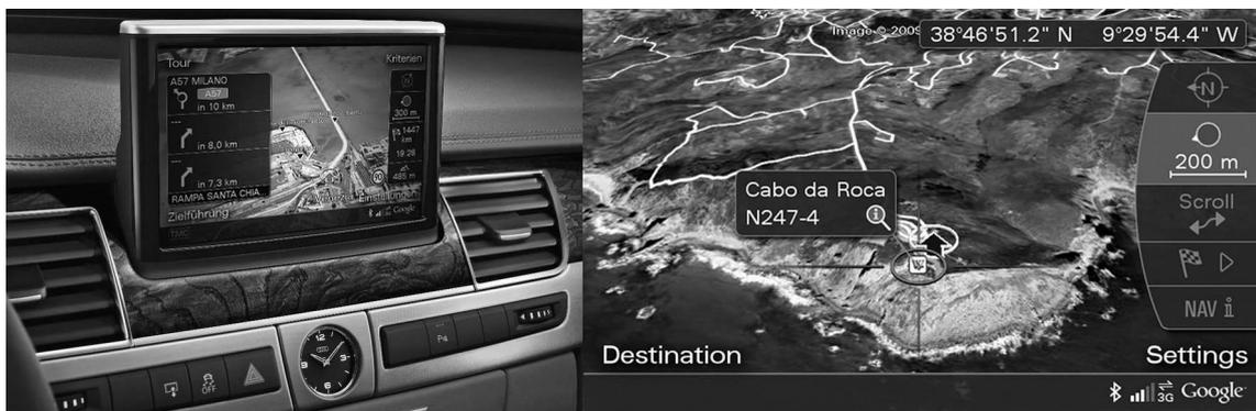
Abbildung 6: In einem Auto von Audi wurde Google Earth in den Bordcomputer integriert und stellt die Grundlage der GPS-Navigation dar. Außerdem erlaubt es bspw. die Synchronisation von Fahrtzielen über das Internet. (REDMER, 2009)
