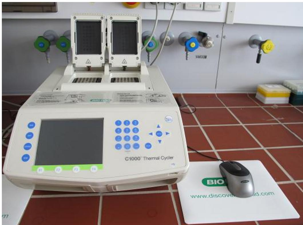
Abbildung 4: Thermocycler C1000™ der Firma BIO-RAD
