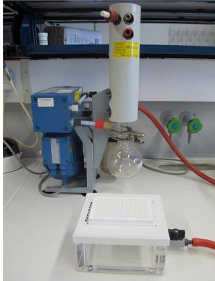
Abbildung 5: Verwendeter Aufbau für die DNA Reinigung. Eine Vakuumpumpe ist über einen Schlauch mit der Nucleo-Fast Platte verbunden.
