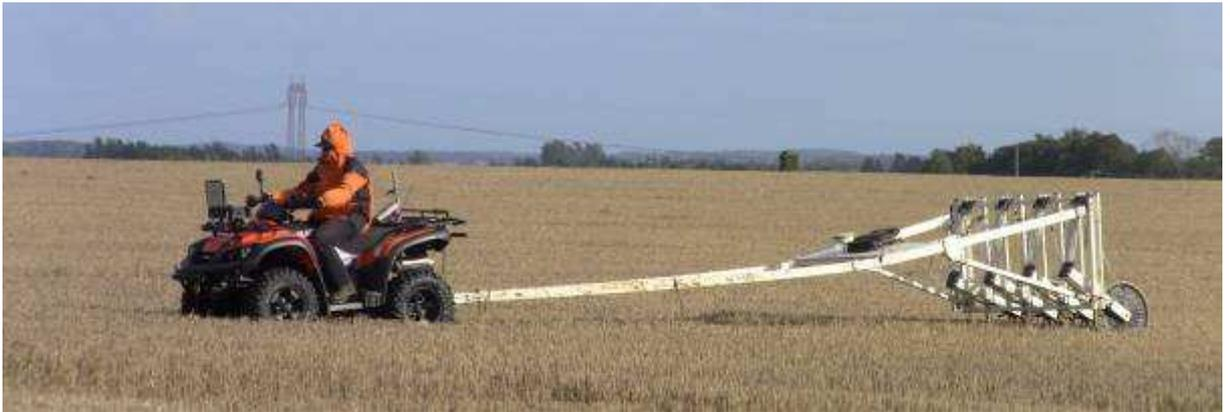
Abb. 16: Motorisiertes Magnetometersystem. (Photo von Trinks, LBI-ArchPro 2010).
