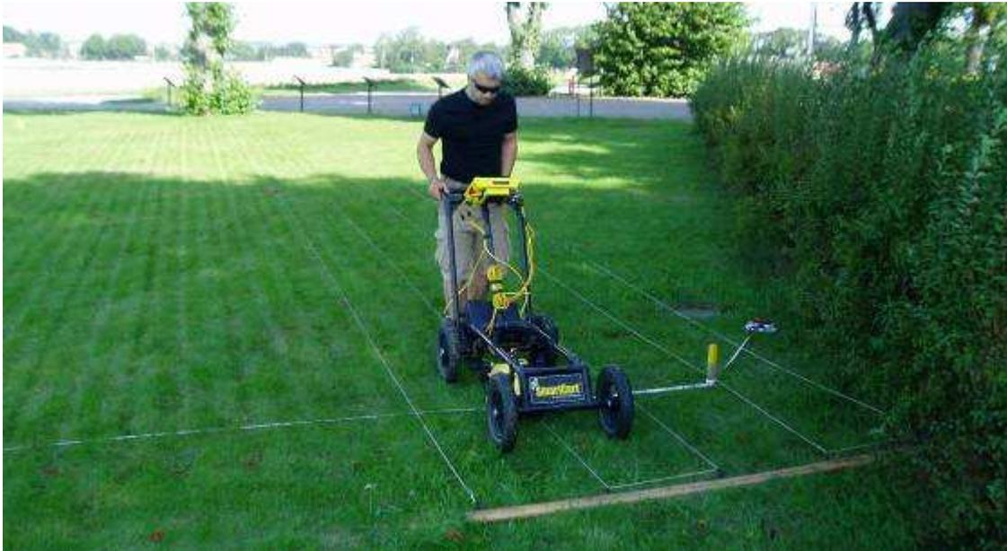
Abb. 18: Sensor & Software Messwagen mit der 500 MHz Antenne (Photo von Gabler 2010 )
