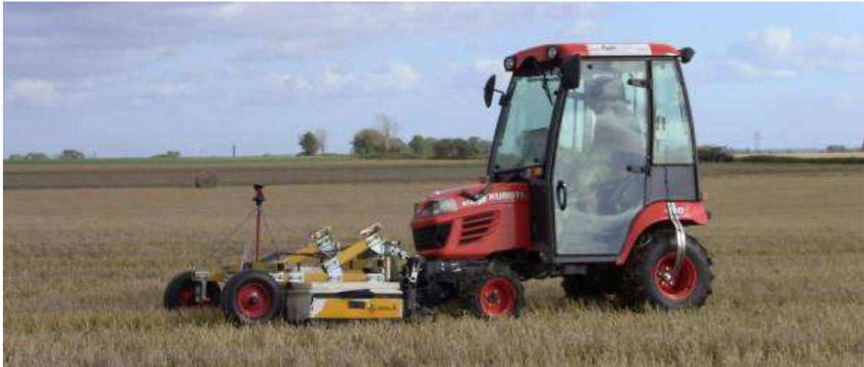
Abb. 17: Motorisiertes 16 Kanal 400 MHz (MIRA), (Photo von Trinks, LBI-ArchPro 2010).
