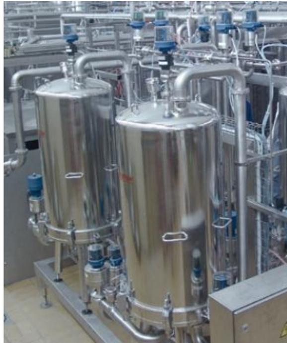
Abbildung 4.18 Tiefenfiltrationsanlage
