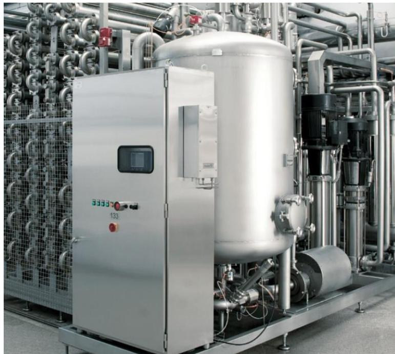
Abbildung 4.11 Indirekte Erhitzungsanlage
