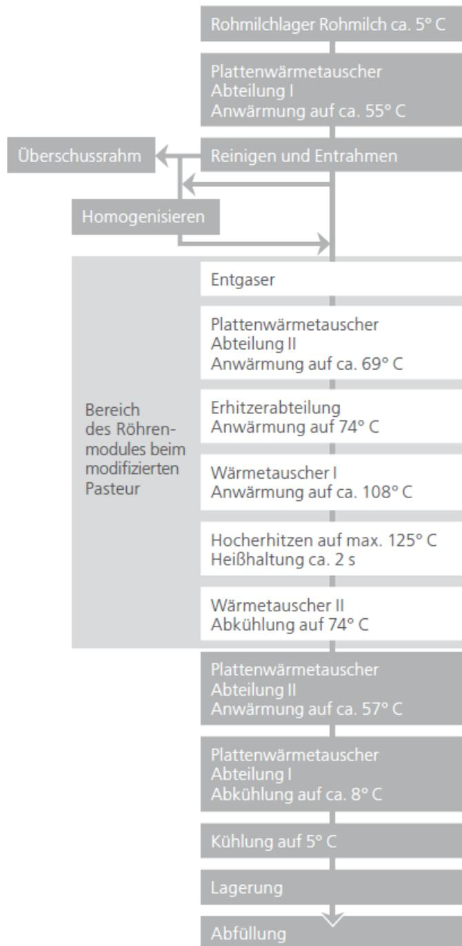
Abbildung 4.14 Blockdiagramm zum Prozessablauf des modifizierten Pasteurs
