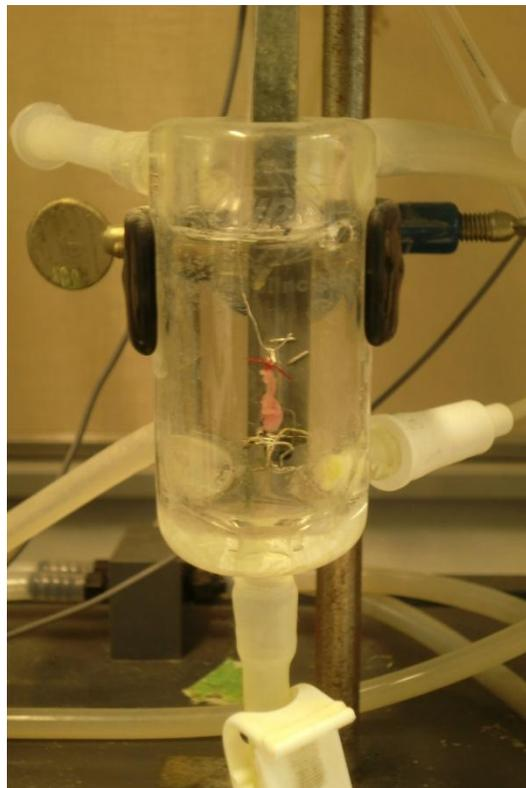
Abbildung 1 : Versuchsapparatur mit fertig isoliertem und eingespanntem Vorhof
