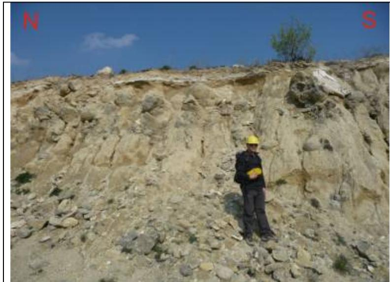
Abb-3.9: (GPS Koordinaten 47.908088, 16.463192, Höhe: 280m), Konglomerat. Er besteht aus ungeschichtetem gräulichem und unzementiertem Sande.
