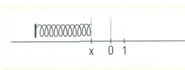
Eine Schraubenfeder mit der Federkonstanten  $k = 400 \frac{N}{m}$  werde von der Gleichgewichtslage 0 ist zur Lage  $x = -0,05m$  gestaucht. Wie groß ist die Arbeit, die die Feder verrichtet, wenn sie sich wieder bis zur Ruhelage ausdehnt?
