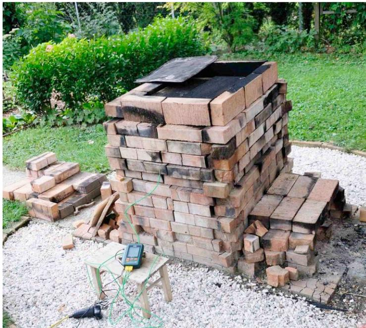
Abbildung 59: Geschlossener Ofen mit zwei Schürkanälen u.r.
