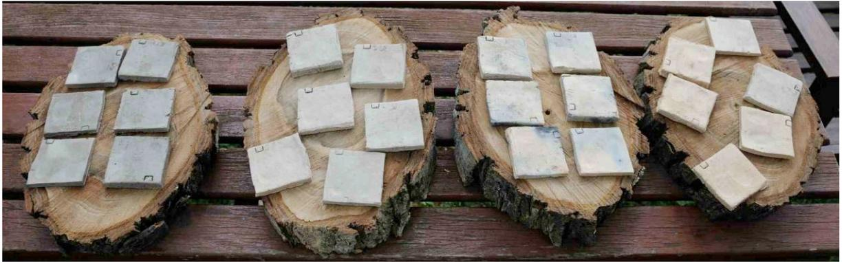
Abbildung 60: Tontafel nach dem Brand. Unterschiedliche Brenntemperaturen sind aus den unterschiedlichen Farbschattierungen ersichtlich. Von links nach rechts:
