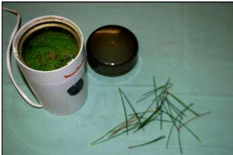
Abb. 3: Pulverisieren der Nadelprobe
