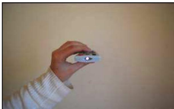
Abb. 13: Blick auf den aktivierten Infrarotsender einer Fernbedienung; gut zu erkennen ist das Leuchten der Infrarotdiode, womit der Nachweis der Infrarottauglichkeit der verwendeten Digitalkamera erbracht ist
