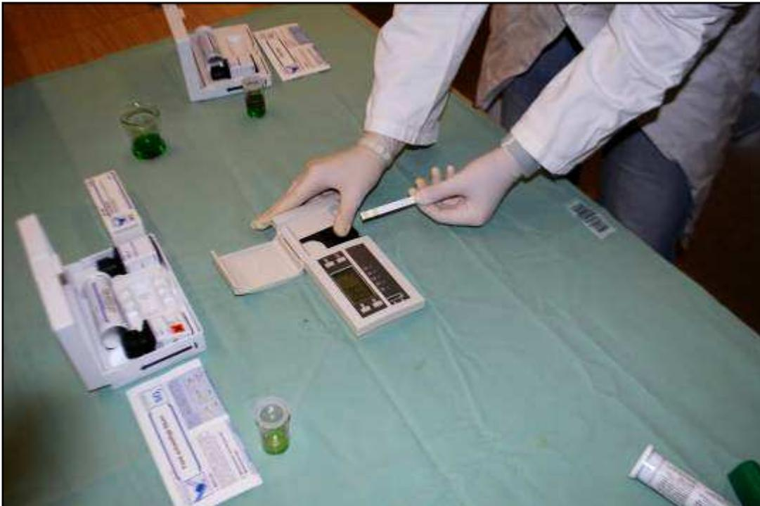
Abb. 8: chemische Analyse der Chlorophyllproben entsprechend der Betriebsanleitung des RQflex und der technischen Anweisungen der Beipacktexte der jeweiligen Testreagenzien der Firma Merck
