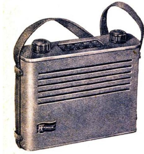
▲ Zwei kuriose Apparate, in deren Umhängeschlaufe sich die Antenne befand. Bester Empfang war nur im „umgehängten“ Zustand gewährleistet.
