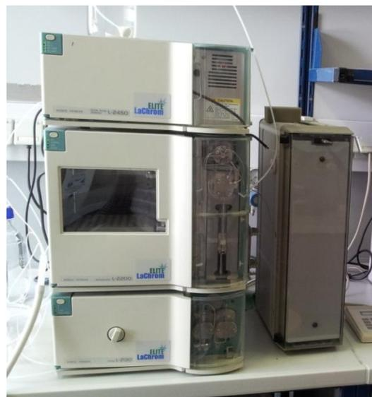
Abbildung 6 HPLC - Anlage
