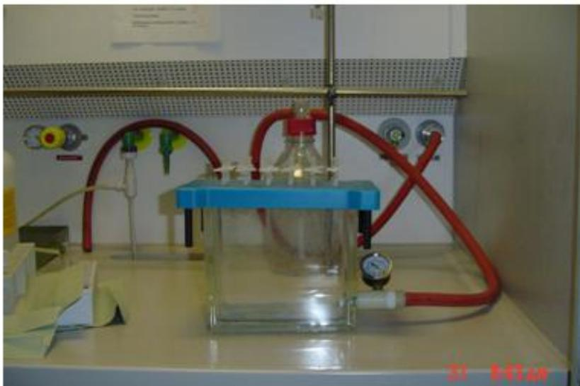
Abbildung 11 Vakuum Einheit zur SPE
