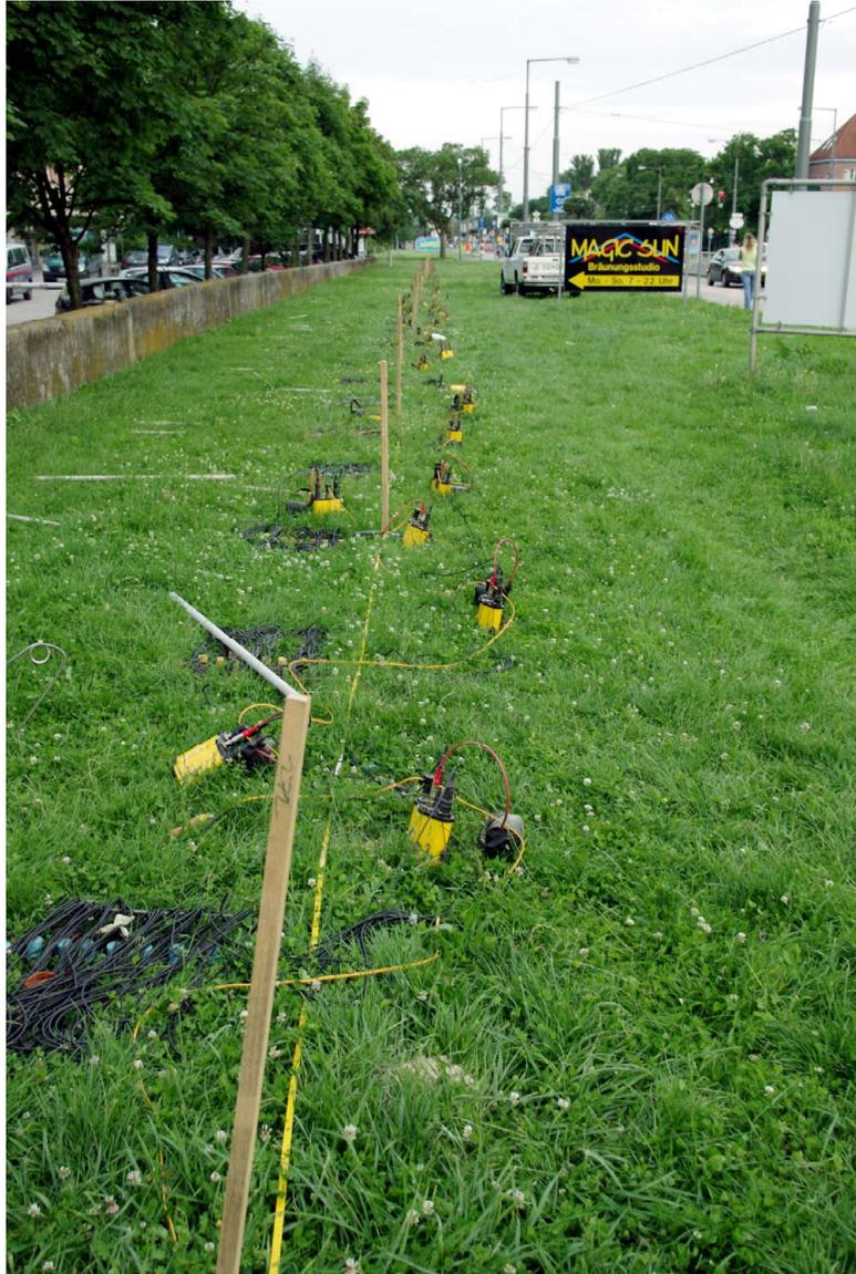
Abb. 2. Seichtseismik-Teststrecke – Streckenabschnitt von ca. 150m (nördlich und südlich von „Gasbohrung“ KB 1103), Durchgeführt von der Joanneum Research – Forschungsgesellschaft mbH.
