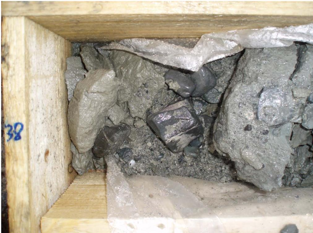
Abb. 1: Bohrkern von KB 1103, 38-38,2m, Gas führende Sand- und Gerölllage.
