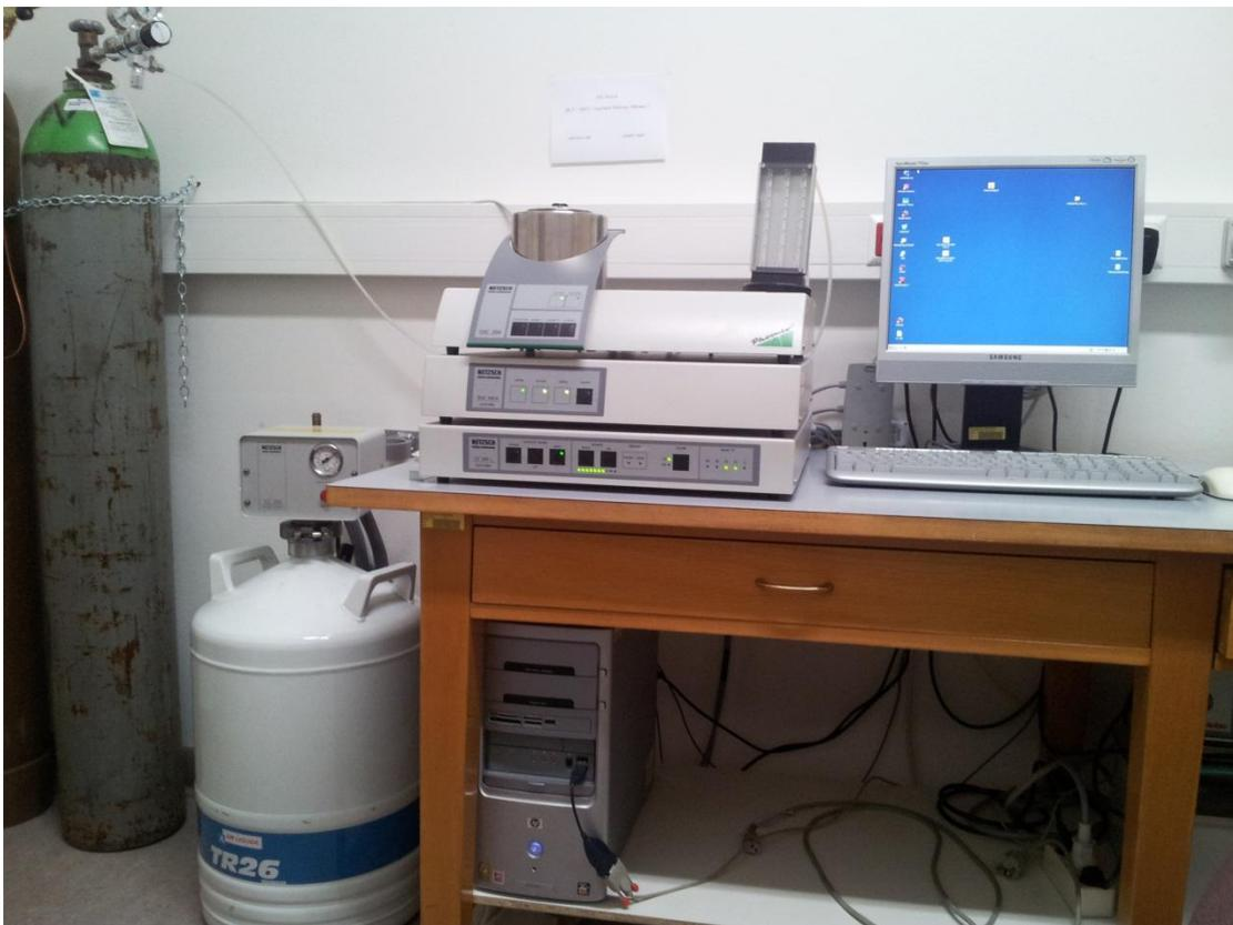
Abbildung 3.5 Heat-Flux DSC
