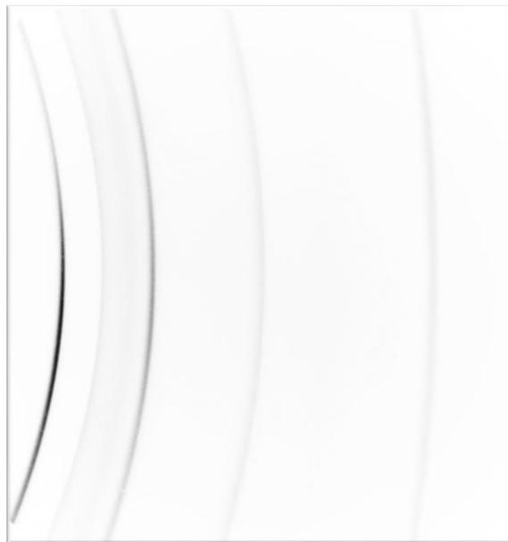
Abbildung 5.3 XPA Aufnahme von HPT Nickel (4 GPa,  $\gamma \approx 6$ ) bei 100°C, in-situ aufgewärmt mit 10 K/min [43]
