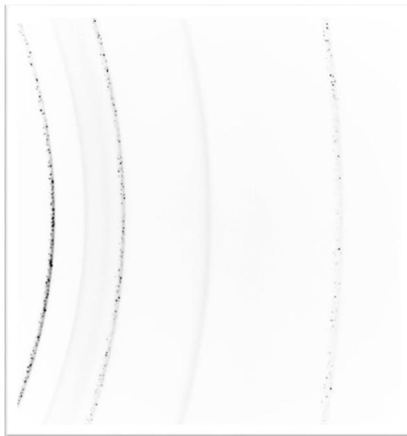
Abbildung 5.4 XPA Aufnahme von HPT Nickel (4 GPa,  $\gamma \approx 6$ ) bei 300°C, in-situ aufgewärmt mit 10 K/min [43]
