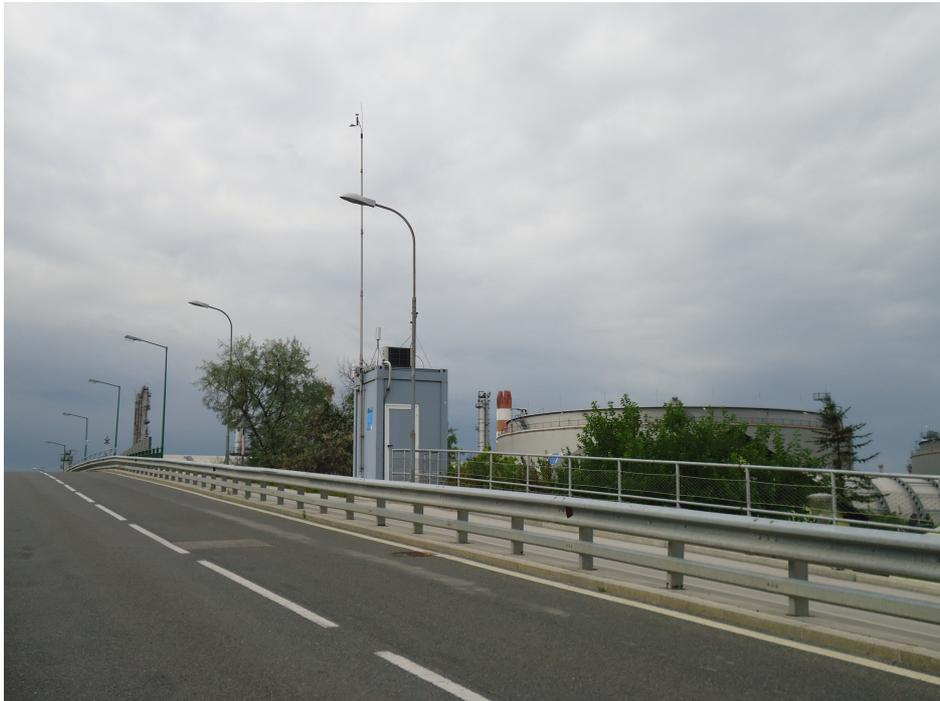
Abb. 4.2.: Luftgütestation Mannswörth/A4 der niederösterreichischen Landesregierung. Wie nach WMO (2008) gefordert, befindet sich der Messkopf 10 m über Grund.
