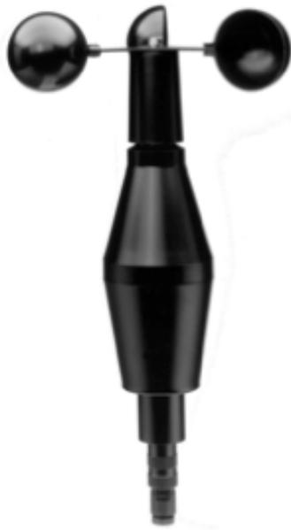
Abb. 3.1.: Schalenkreuzanemometers der Firma Theodor Friedrichs (Manual Theodor Friedrich & CO)
