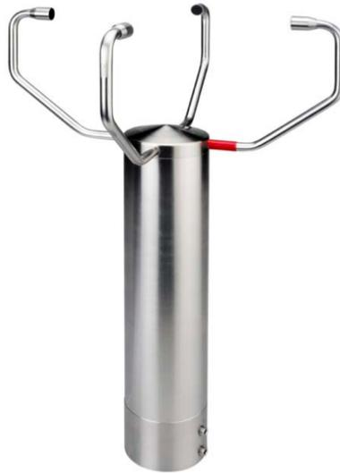
Abb. 3.5.: 2D Ultraschallanemometer, über zwei Messstrecken mit je zwei Messköpfen können Windgeschwindigkeit (horizontal) als auch Windrichtung erfasst werden (aus Manual Adolf Thies GmbH & Co.KG)
