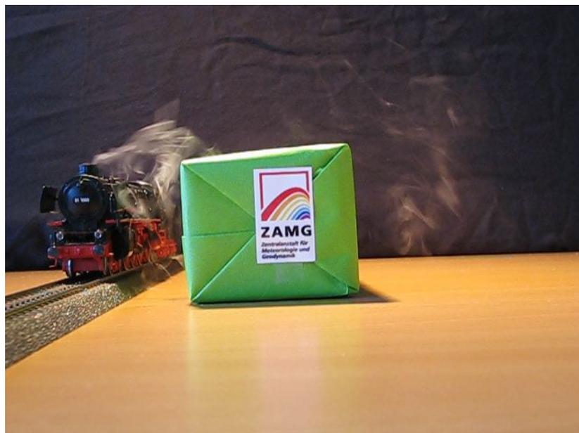
Abb. 2.9.: Zwischen Modellbahn und Probekörper bildet sich ein Wirbel, aber auch hinter dem Hindernis sind Wirbel zu erkennen, in der sogenannten Kavitätszone.
