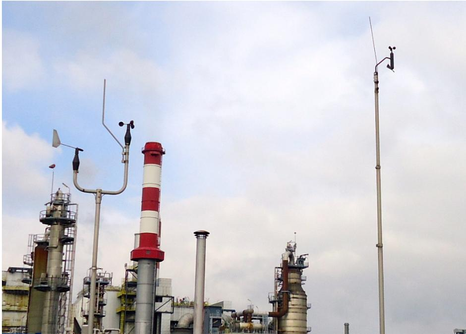
Abb. 3.2.: Schalenkreuzanemometer der Firma Theodor Friedrichs mit getrennter Windfahne, links und rechts Schalenkreuzanemometers der Firma Kroneis mit Windfahne direkt unterhalb der Windgeschwindigkeitserfassung, das Foto zeigt die Messstation Borealis BFW/LDX
