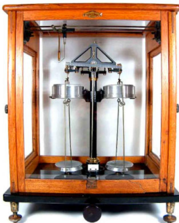
Abbildung 30: Mikrowaage mit Balkenreiter
