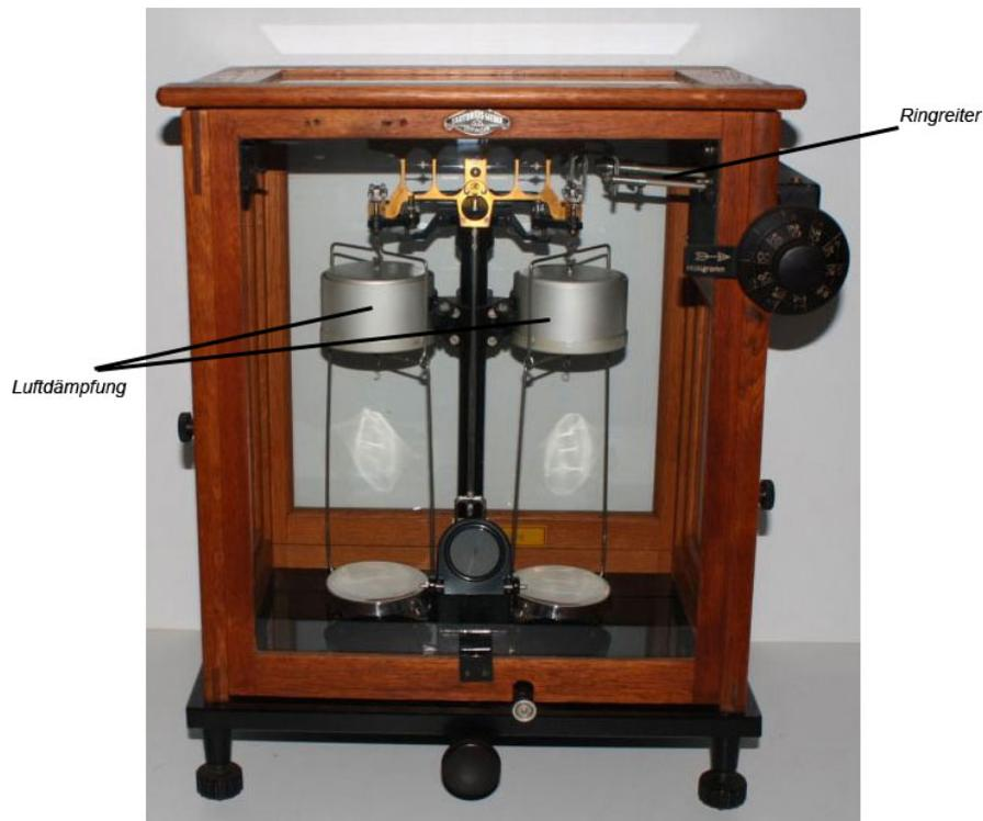
Abbildung 29: Reiterlose Mikrowaage mit Bruchgrammauflage
