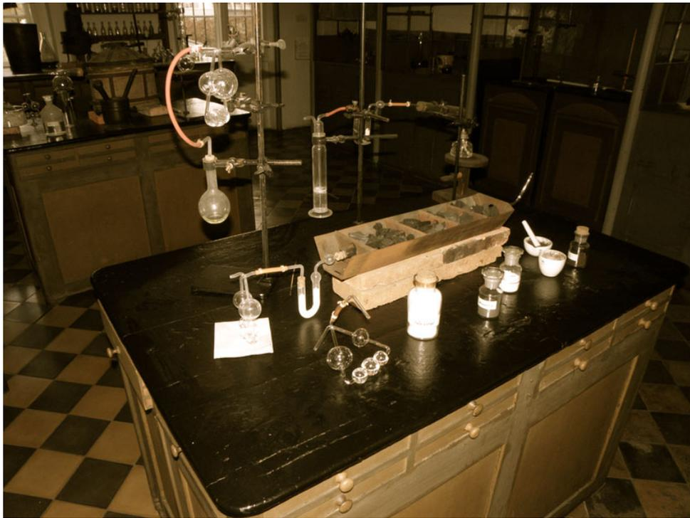
Abbildung 4: Elementaranalyse inkl. Fünfkugelapparat
