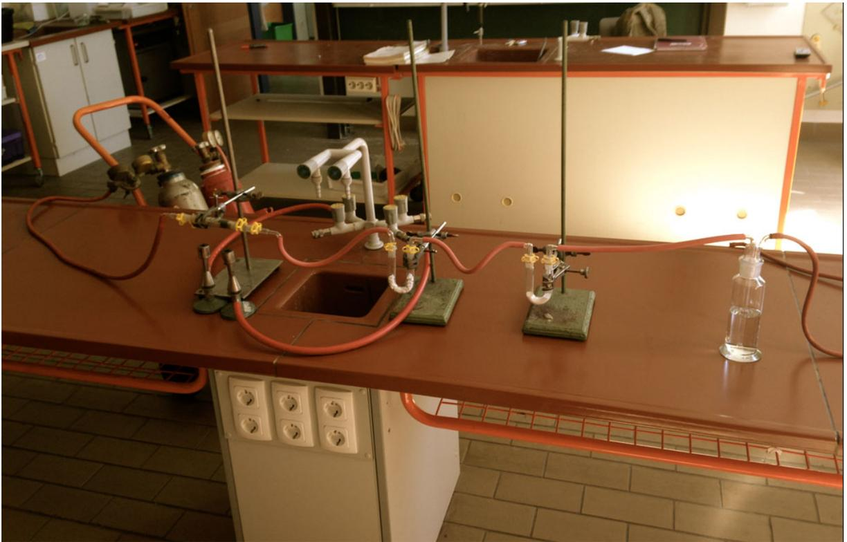
Abbildung 33: Einfache Versuchsanordnung zur Elementaranalyse
