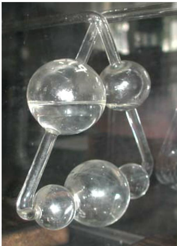
Abbildung 8: Fünfkugelapparat
