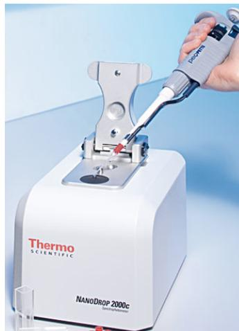
**Abbildung 36: NanoDrop Spektralphotometer; aus [122], modifiziert**
