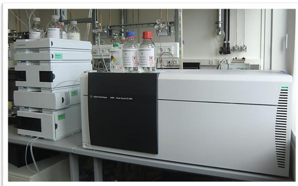
**Abbildung 3: LC-QQQ-MS HPLC 1200 kombiniert mit 6460 Triple Quadrupole (verwendetes Gerät)**
