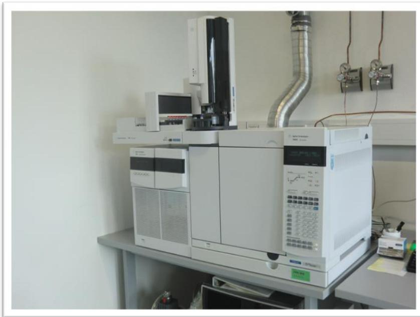
**Abbildung 2: GC-QQQ-MS GC 7890A kombiniert mit 7000B Triple Quadrupole (verwendetes Gerät)**
