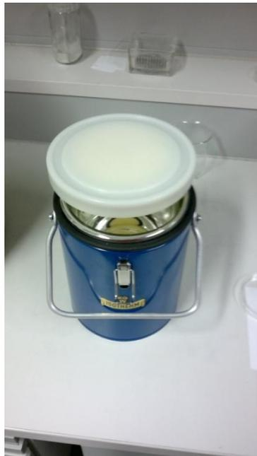
Abb. 21: Dewar-Gefäß mit flüssigem Stickstoff
