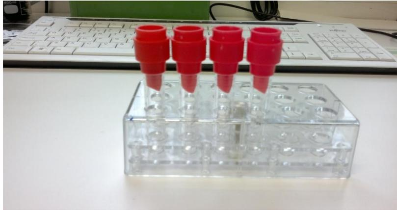
Abb.14: Filtrierung durch Filter CellTrics®
