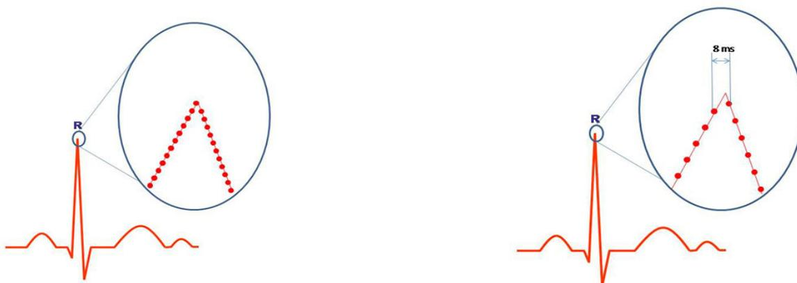
Abbildung 5: Exakte Bestimmung der R-Zacke durch eine hohe Auflösung
