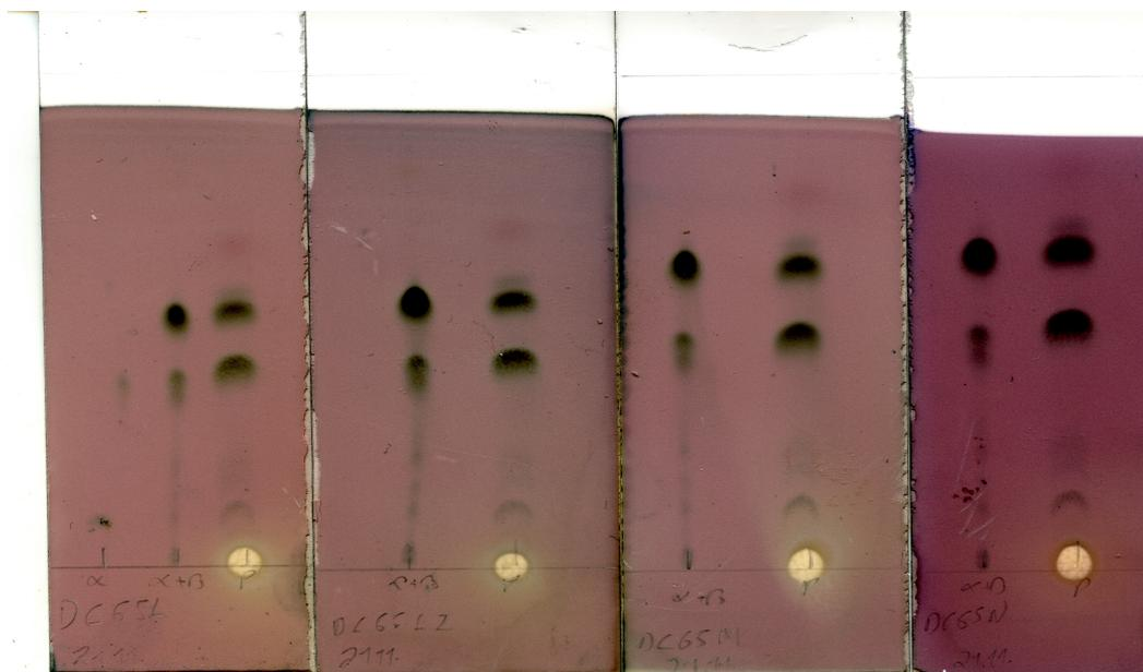
Abbildung 16: Die DC-Platten zeigen anhand der entstanden Produktflecken die Gleichgewichtseinstellung zwischen der  $\alpha$ - und der  $\beta$ -Form von 2-azido-2-desoxy-D-glucopyranosyl nitrat unter dem Einfluss von Tetrabutylammoniumnitrat.
