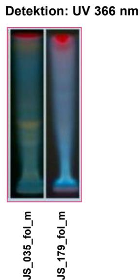
**Abb. 49:** Analyse der methanolisch extrahierten Blattmaterialien (Abbildung 5, Seite 8) mittels HPTLC (Tabelle 6, Seite 20) entwickelt in System 3 und Derivatisiert mit Naturstoffreagenz A (Tabelle 7, Seite 21); Gruppe 3: Fingerprints die weder BT1 noch JK1 enthalten
