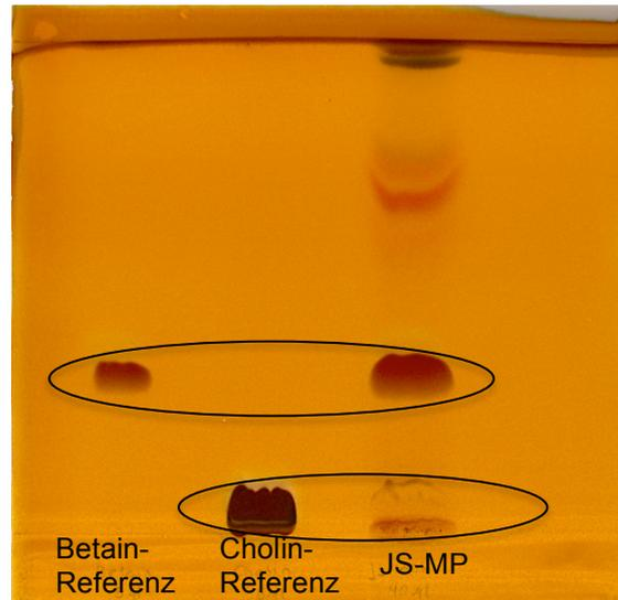
**Abb. 19:** Analyse von **JS-MP** (**Abbildung 8, Seite 11**) mittels DC, entwickelt in System 4 und derivatisiert mit spezial Dragendorffreagenz (**Tabelle 7, Seite 21**), zur Verifizierung von Betain und Cholin mittels Reinsubstanzen
