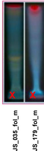
**Abb. 52:** Analyse der methanolisch extrahierten Blattmaterialien (Abbildung 5, Seite 8) mittels HPTLC (Tabelle 6, Seite 20) entwickelt in System 3 derivatisiert mit Naturstoffreagenz A (Tabelle 7, Seite 21);
