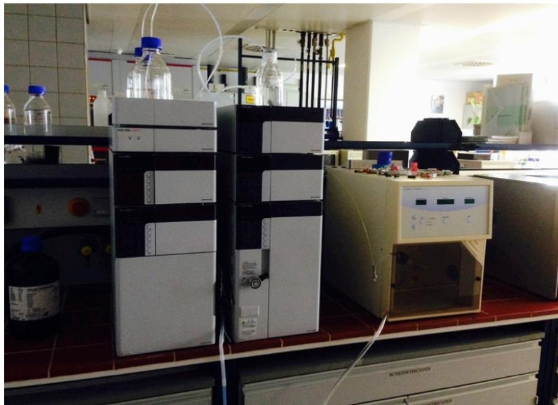
**Abb. 12: Verwendete HPLC der Firma SHIMADZU samt ELSD (rechts davon)**
