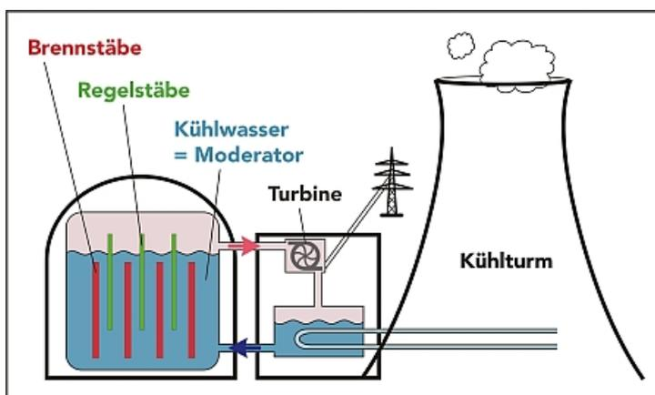
Abbildung 10: Prinzip eines Atomkraftwerks
