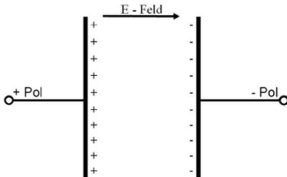
Abbildung 61: Das E-Feld eines Kondensators
