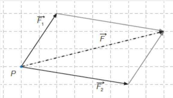
Abbildung 37: Lösung, Kräftezerlegung
