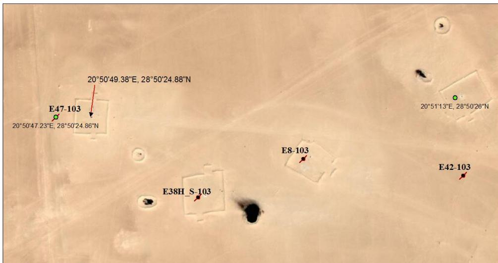
*Abb. 60: Satellitenbild zur Qualitätskontrolle der Bohrungskordinaten*
