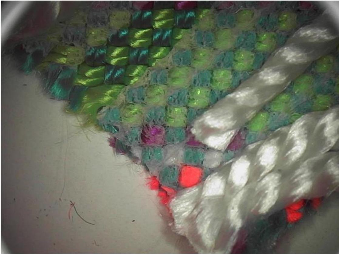
**Abbildung 3: Geklebter Kern. Sichtbar sind Reste des Klebestoffs am Mantel, der die Litzen des Kerns mit dem Mantel verbindet.**
