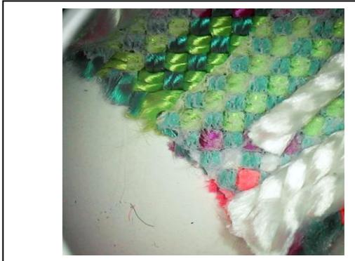
Abbildung 43: Seilaufbau Beal Top Gun
