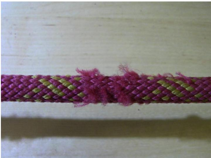
Abbildung 38 Test eines Verbindungsmittels (Gebrauchsspuren)
