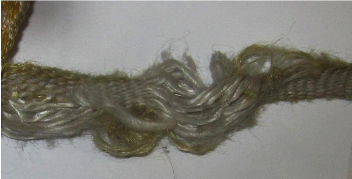
Abbildung 13: Ablegereife Schlinge auf Grund von Abnutzung. Haltekraft mehr als 10 kN.
