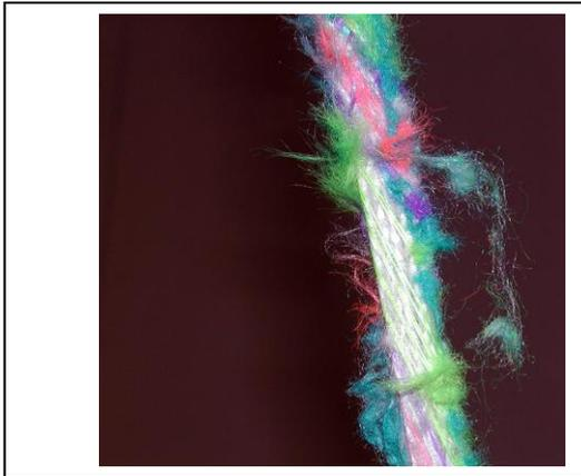
Abbildung 52: Top Gun bei 29.500 Zyklen: Mantelriss
