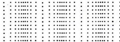
Abbildung 16: Ausbreitung einer Longitudinalwelle in Festkörpern (Dickreiter, 2014: 12)
