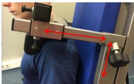
**Abb. 59: Vertikale und horizontale Einstellung der Schulterfixierung**
