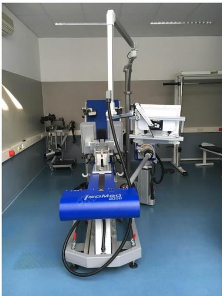
**Abb. 24: Frontalansicht des Isomed\_2000 inklusive des Linearmoduls (eigene Aufnahme)**
