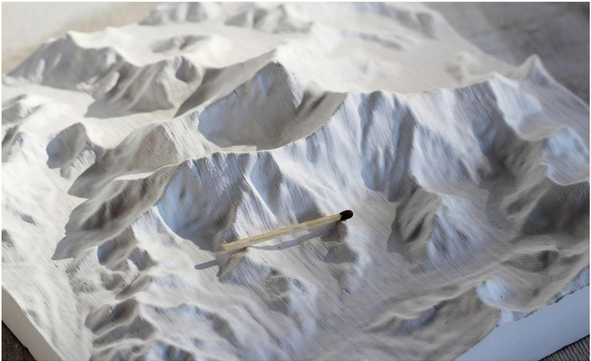
*Abb. 24: Sichtbarer Treppenstufeneffekt, Mount Everest Rohmodell aus dem 3D Drucker. M 1:1.000.000. Quelle-Bild: (C) Wolfgang Pusch (bergmodelle.de)*
