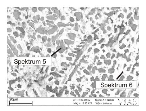
Figure 13: QBSD – Bild, Gussgefüge, in die Silbermatrix (weißgrau) sind Cu – Zn – Pb Entmischungen (dunkelgrau – dendritenförmig angeordnet) eingelagert (Aufnahme: M. Mehofer).
