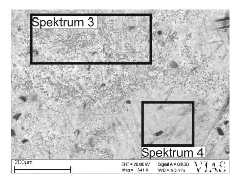
Figure 12: QBSD – Bild, Detailaufnahme des Grundmaterials lässt inhomogenen Elementverteilung im Silber erkennen (Aufnahme: M. Mehofer).
