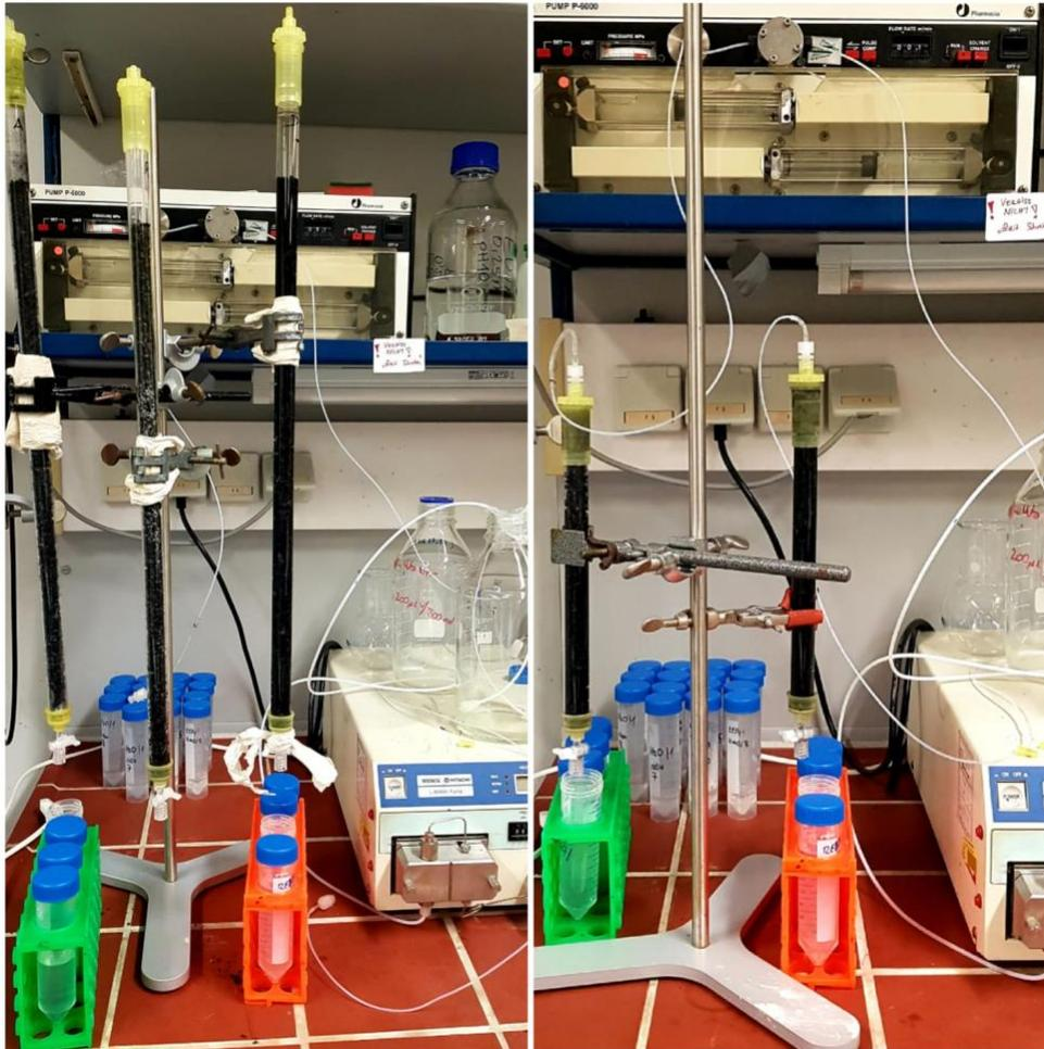
Abbildung 15: U-238 Extraktionsversuchsordnung links für große Säulen, rechts für kleine Säulen
