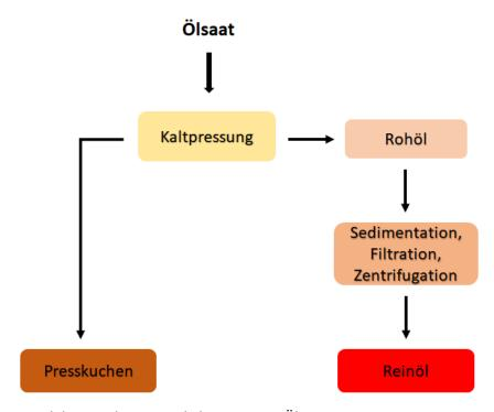
Abbildung 1: Produktionsschema von kaltgepressten Ölen
