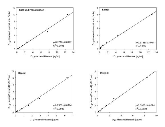
Abbildung 10: Isotopen-Verdünnungsreihe für die Hexanal-Bestimmung
