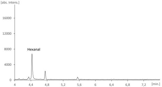
Abbildung 8: Repräsentatives Chromatogramm der Fragmentionen von D12-Hexanal (m/z 80) und Hexanal (m/z 72) in Ölsaat und Presskuchen
