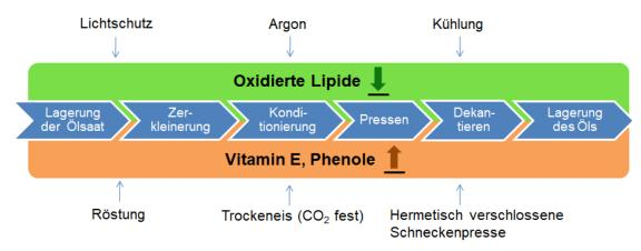
Abbildung 4: Strategien zur Verbesserung der oxidativen Stabilität während der Produktion von kaltgepressten Ölen (mod. nach Grosshagauer et al., 2019)
