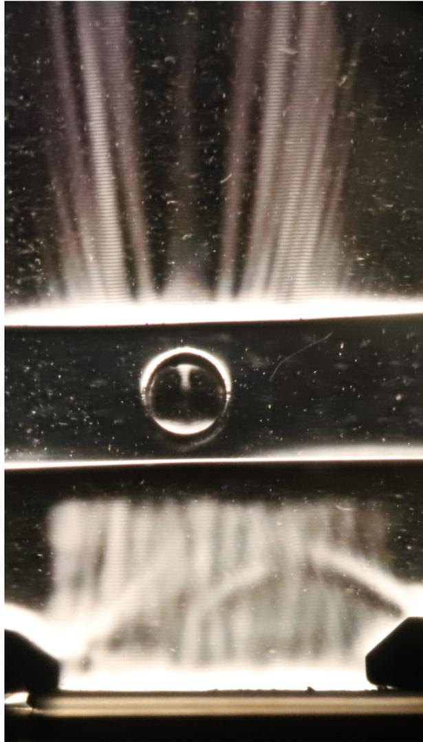
Abbildung 25: Erste Aufnahme des Beschallten Plexiglasquaders mit Bohrung. Am unteren Bildrand ist das Quarzplättchen erkennbar, mittig die Plexiglasplatte mit Bohrung und oberhalb davon ein schallfreier Raum. *Quelle: Anna Kopf und Franz Sachslehner.*
