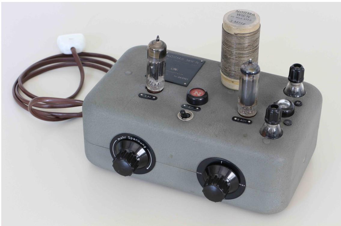
Abbildung 11: UNI-Ultraschall-Demonstrationsapparatur, Frequenzgenerator. *Quelle: Anna Kopf und Franz Sachslehner.*
