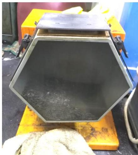
**Abb. 16: Trommelmaschine zum Simulieren von taphonomischen Effekten.**
