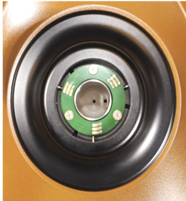
Abb. 12 Probenzelle und Referenzzelle
