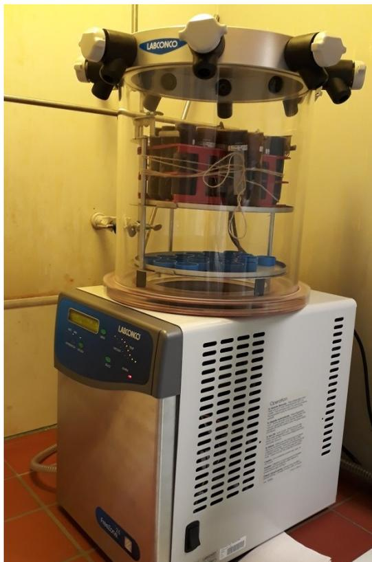
Abbildung 2: Gefriertrockner „FreezeZone 2.5“ der Firma Labconco (eigenes Bild)
