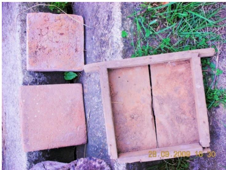
Abb. 12.5: Ziegelei Kloiber Fratres: Bodenplatten und zugehöriger Model
