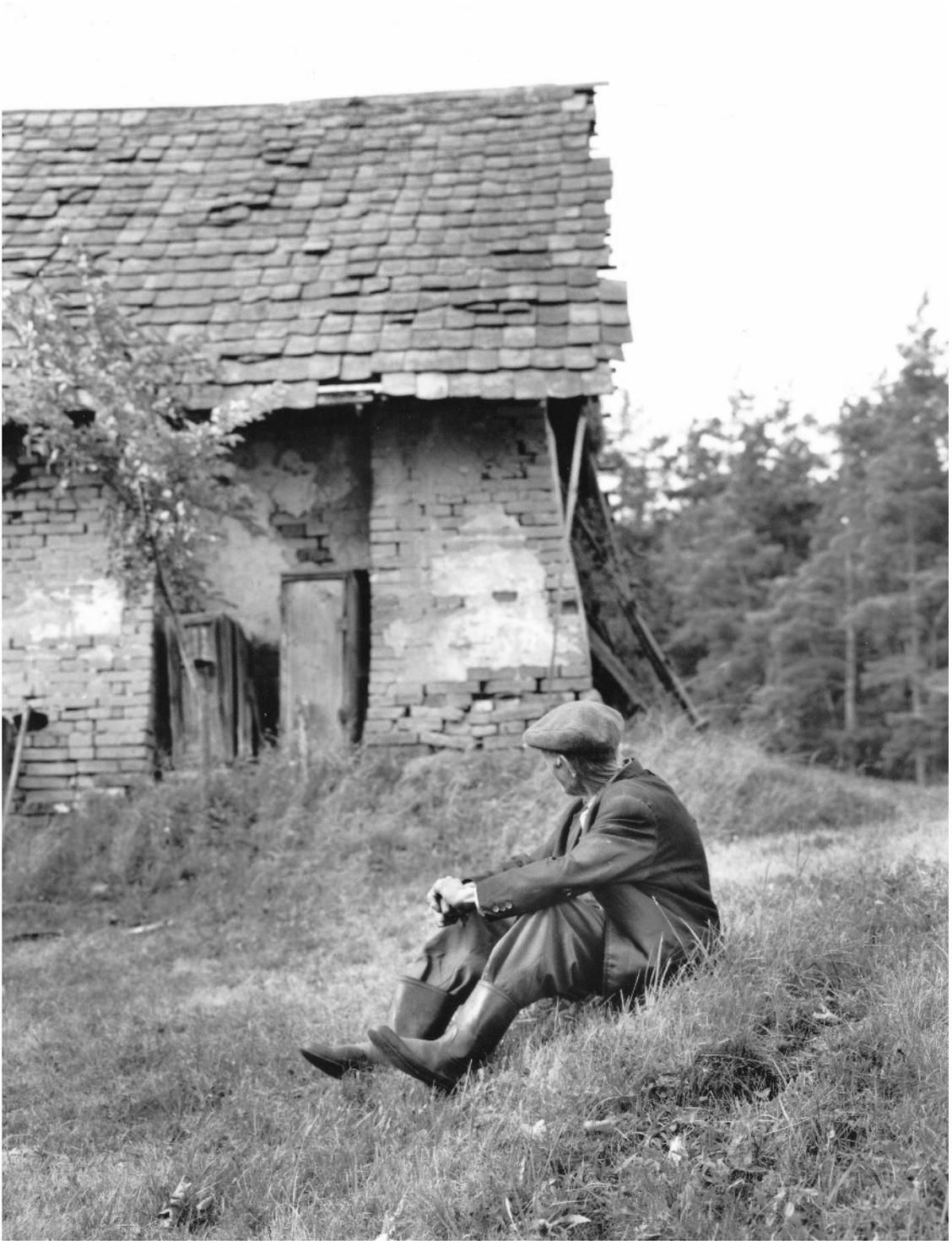
Abb. 60: Friedrich Kloiber vor Ziegelofen III Südansicht (Identifikationsnr. 12). Die Einfachdeckung mit Spließen mit vielen verbogenen Dachziegeln ist gut zu erkennen. Aufnahme ungefähr um 1997.
